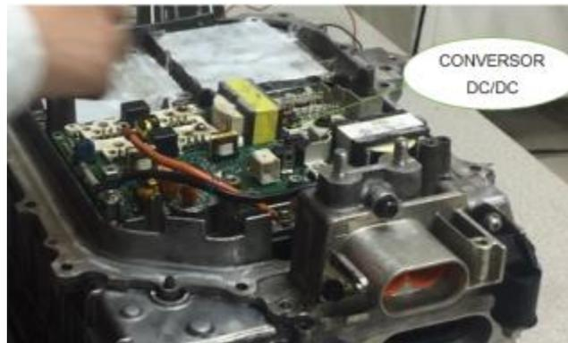
2. Colocar el módulo IPM y el reactor juna a la placa DC/DC
