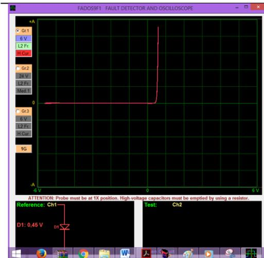
Entre el pin 2 y 3 genera una curva característica de un diodo.
