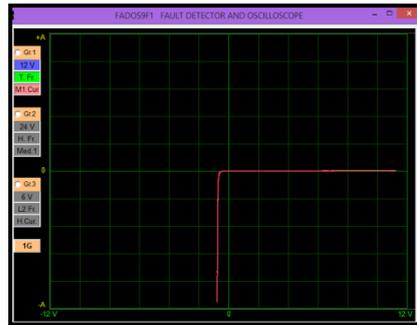
**Figura 19. Curvas o firmas básicas de un Diodo zéner.**
