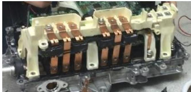
4. En la tapa inferior se monta el capacitor de mayor capacidad junto con la resistencia de descarga.
