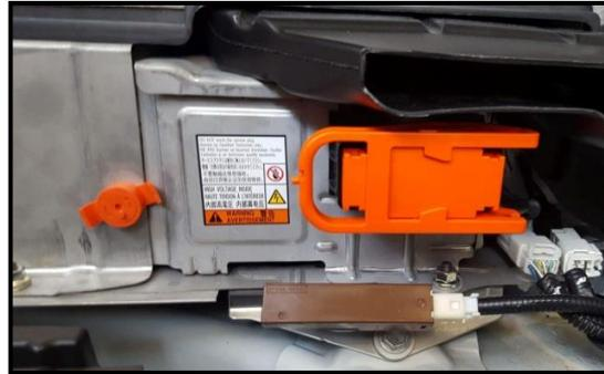
**Figura 10. Jumper de seguridad Toyota Prius**
