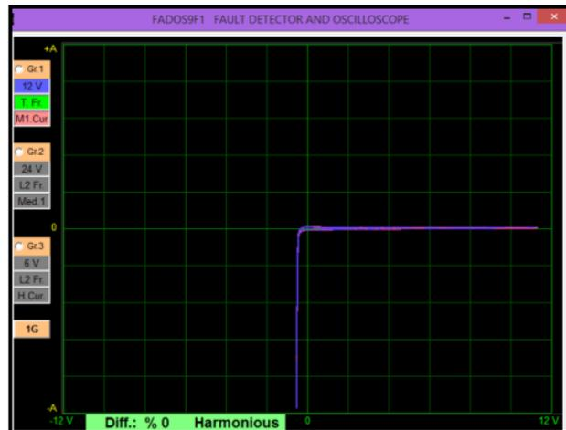
**Figura 21. Curva obtenida entre el colector y emisor del transistor NPN.**
