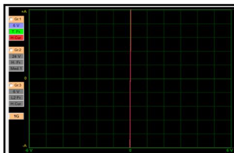
**Figura 13. Figura de Lissajous circuito en corto**
