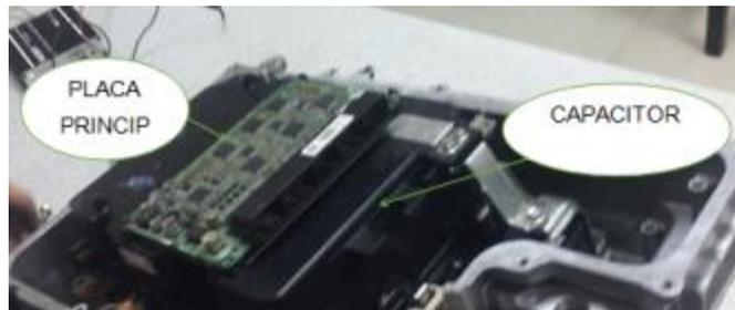
5. Girar al inversor y proceder a colocar y ajustar los pernos de la carcasa
