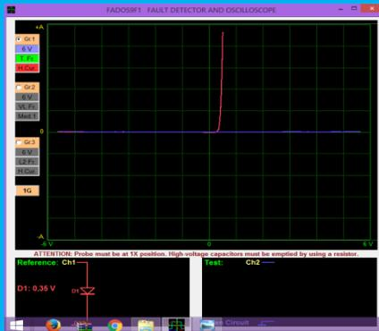
Entre G y A se genera una curva de diodo de germanio, que al compararlo con el circuito del inversor se encuentra en buen estado.
