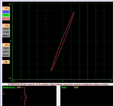
En el diagnóstico del sensor de velocidad se encuentra la curva característica de una bobina debido a que el sensor es de tipo inductivo
