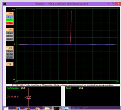
Entre E y B se genera una curva de diodo de germanio, que al compararlo con el circuito del inversor se encuentra en buen estado.
