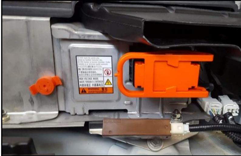
Cada que se realiza una operación de mantenimiento se tiene que retirar el Jumper por seguridad protegiendo el sistema de descarga eléctrica de alta tensión
