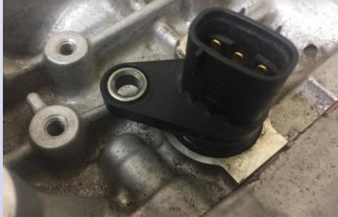
Sensor de velocidad del motogenerador
