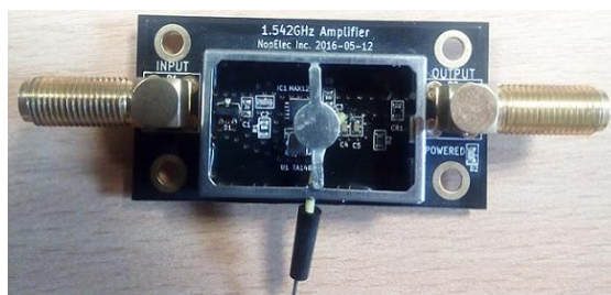
Figura 40 Vista superior del LNA MAX12000 sin cubierta
