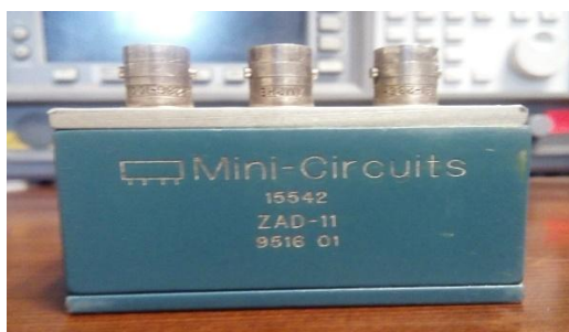
Figura 47 Vista frontal del mixer ZAD-11
