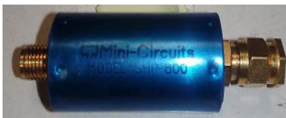
Figura 43 Vista superior del filtro pasa altas SHP-800
