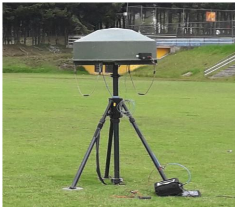
Figura 28 Arreglo de antenas con la carcasa en vista frontal
