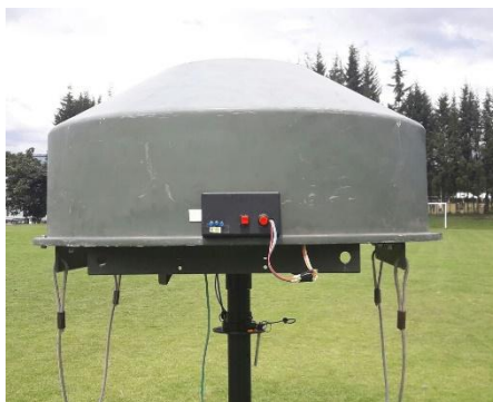
Figura 45 Circuito de control montado en la antena
