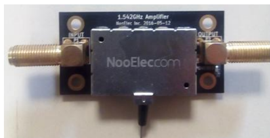
Figura 39 Vista superior del LNA MAX12000 con cubierta
