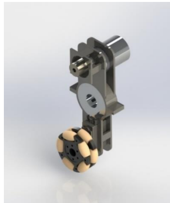
Figura 63 Portaherramientas en eje descentrado
