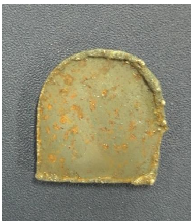
Figura 105 Orejas del anillo con rebabas y aristas vivas
