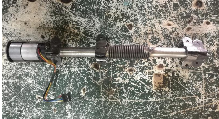
Figura 118 Cuerpos del robot unidos utilizando un resorte
