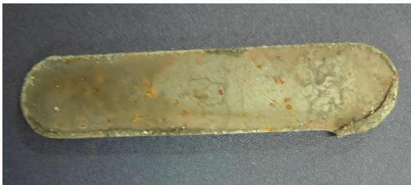
Figura 104 Eslabón de 50 mm con rebabas y aristas vivas
