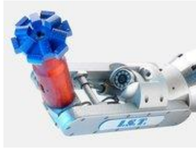
Figura 34 Robot para limpiar tuberías con taladro
