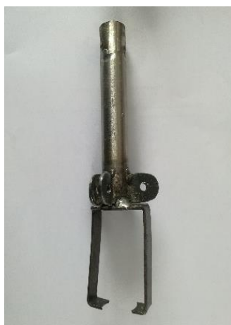
Figura 115 Estructura de soporte del motor para limpieza de tubería soldada al eje del robot
