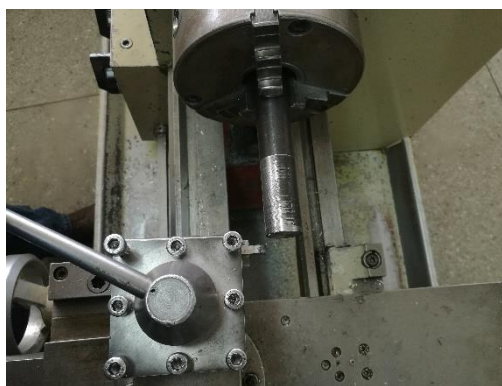
Figura 109 Reducción del diámetro del cilindro metálico
