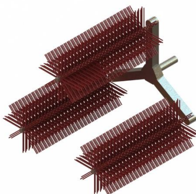
Figura 64 Portaherramientas en eje centrado
