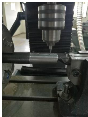
Figura 110 Fresado de ranuras guías en el cilindro metálico
