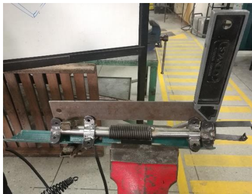
Figura 117 Uso de una escuadra para impedir el desfase de las orejas entre los dos cuerpos del robot
