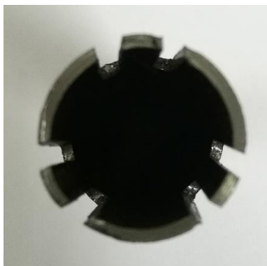
Figura 111 Ranuras guías para colocar las orejas
