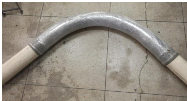
Figura 136 Tubería horizontal con un accesorio tipo codo de radio largo de 90^\circ
