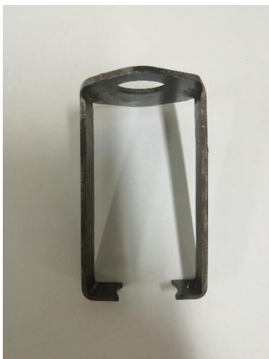
Figura 114 Estructura del acople del motor para la limpieza de la tubería
