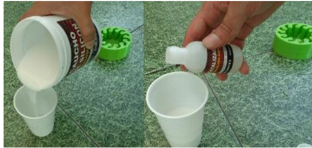
Figura 109. (De izquierda a derecha) Mezcla del caucho de silicona y mezcla del catalizador
