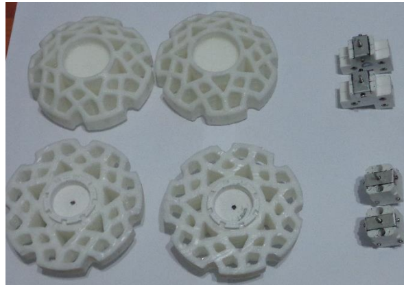
Figura 112. Etapa final de curado y desmolde
