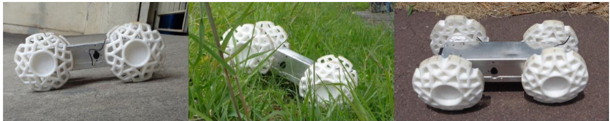
Figura 120. Prueba en plano inclinado en concreto, césped y asfalto
