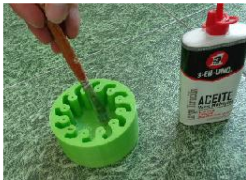
Figura 108. Aplicación de aceite en el molde
