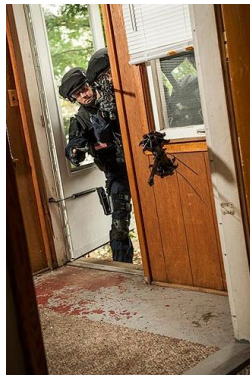
Figura 25. Throwbot XT lanzado hacia el interior de una casa Fuente: (Reconrobotics, Reconrobotics, 2015)
