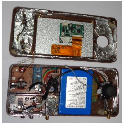
Figura 106. Masa a tierra del control remoto
