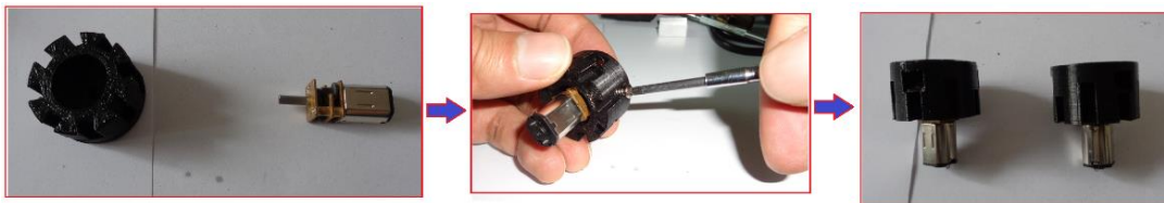
Figura 110. Ensamble aro y motoreductor, antes de colocar dentro del caucho de silicona
