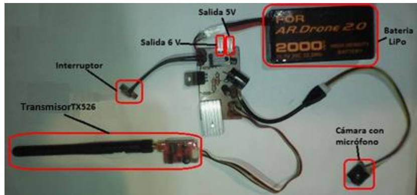
Figura 100. Placa electrónica de alimentación al robot
