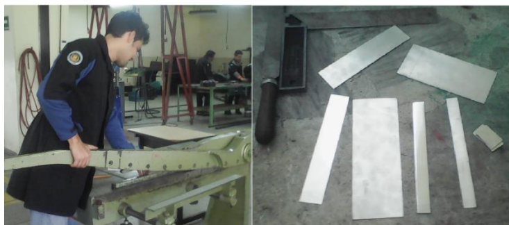
Figura 101. Corte a medida de placas de aluminio
