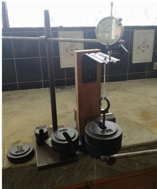
**Figura 98.** Prueba de flexo-torsión ménsula sin optimizar
