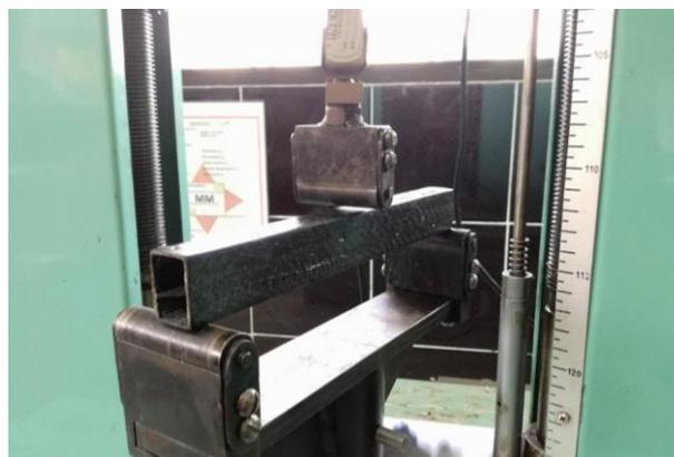
**Figura 100.** Prueba de flexión en viga sin optimizar
