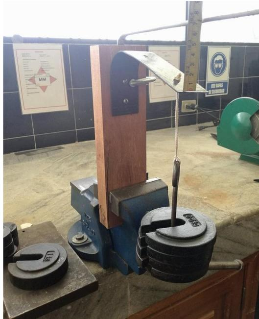
**Figura 96.** Prueba de flexo-torsión ménsula sin optimizar
