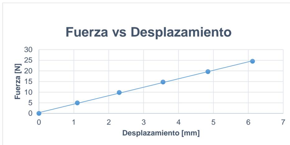
**Figura 99.** Diagrama Fuerza vs Desplazamiento de ménsula optimizada
