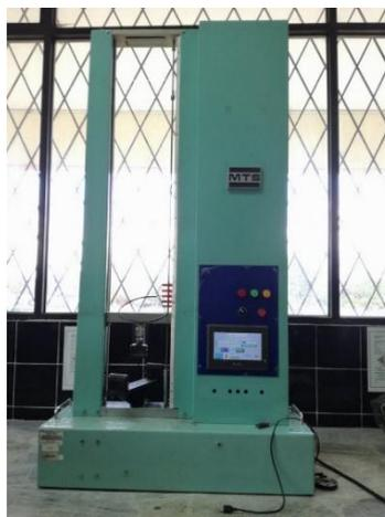
**Figura 90.** Máquina de ensayos universales MTS
