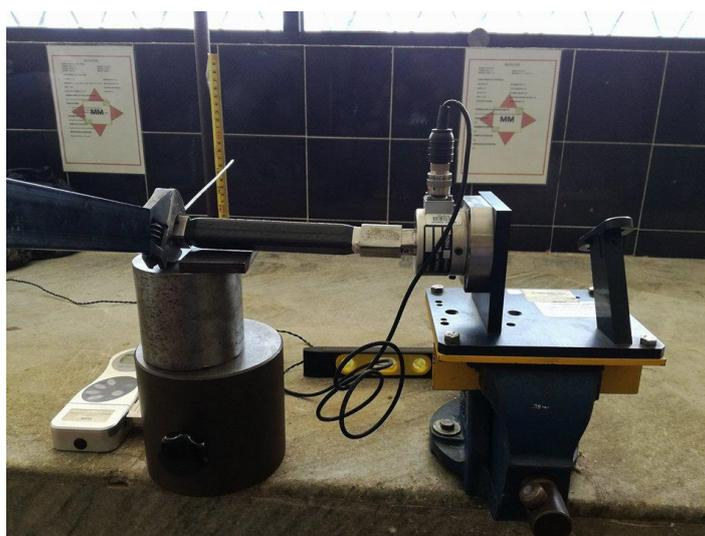
**Figura 106.** Prueba de torsión a viga optimizada
