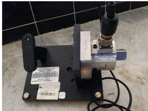
**Figura 89.** Calibrador de torquímetro
