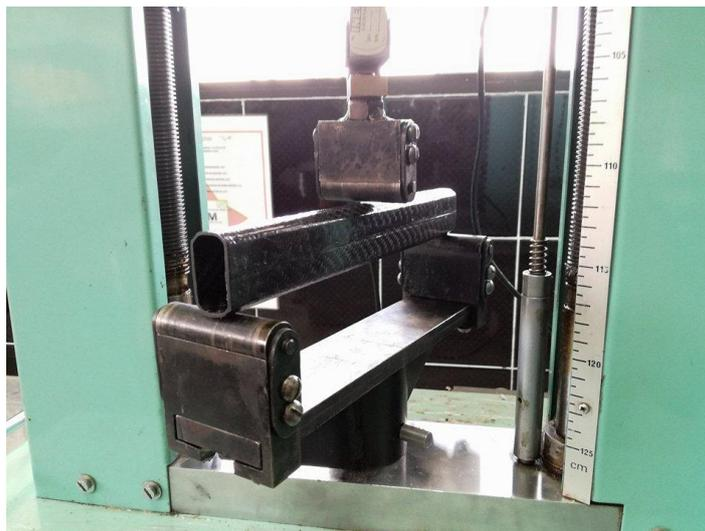
**Figura 102.** Prueba a flexión de viga optimizada
