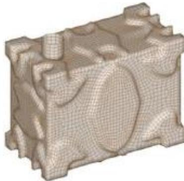
**Figura 26.** Optimización Topográfica
