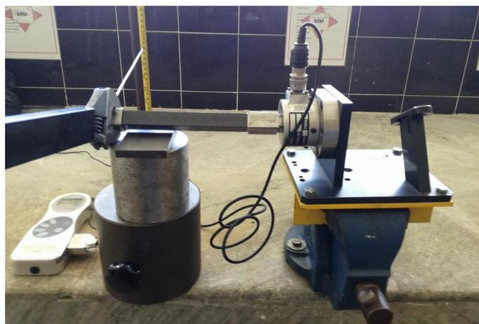
**Figura 104.** Prueba de torsión a viga no optimizada
