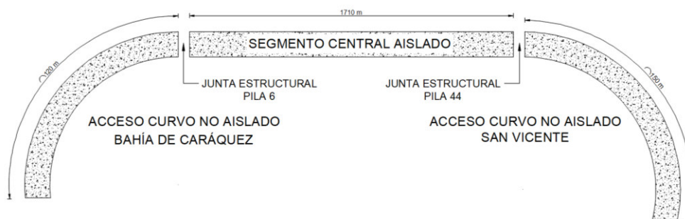
Figura 66 Segmento Central Aislado y Segmento no Aislado
