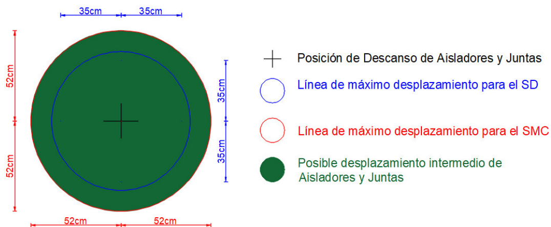
Figura 69 Desplazamientos Esperados en Todas las Direcciones Durante un Sismo
