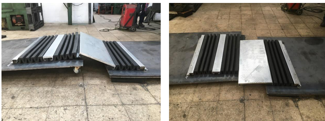
Figura 78 a) Desplazamiento Longitudinal, Vertical en la Nueva Versión del Sello JSGD, b) Desplazamiento Transversal en la Nueva Versión del Sello JSGD
