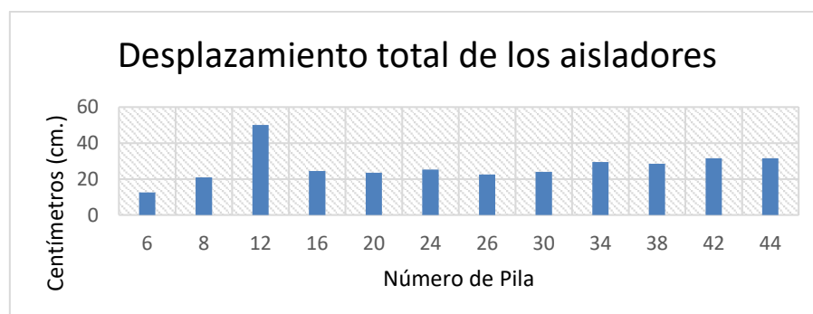
Figura 27 Desplazamiento en los aisladores sísmicos (cm)
