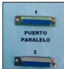
Figura 47. Conector DB25 puerto paralelo
