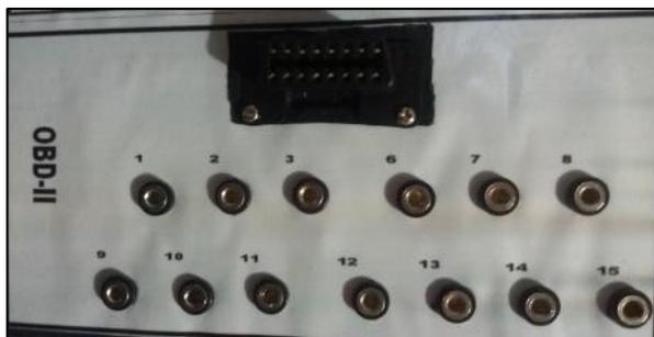
Figura 49. Conector tipo OBD-II
