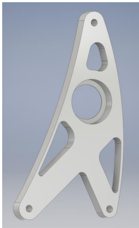
Figura 31. Rediseño de soporte izquierdo, optimizado con ayuda del software
