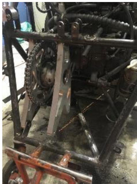
Figura 65. Alineamiento de la cadena de transmisión
