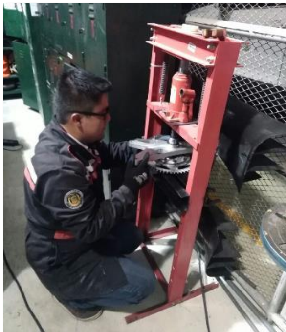
Figura 63. Colocación de los nuevos soportes en el diferencial
