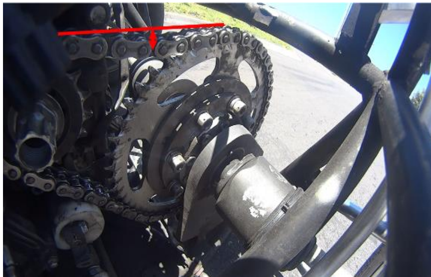
Figura 70. Estado de reposo del conjunto diferencial con soportes antiguos
