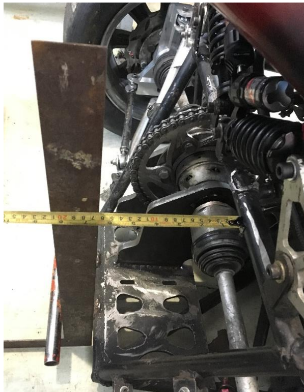
Figura 32. Toma de medidas del soporte original
