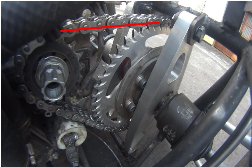
Figura 72. Estado de reposo del conjunto diferencial con soportes nuevos
