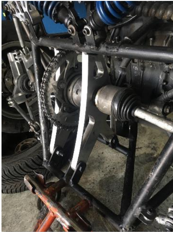
Figura 68. Conjunto diferencial armado y ensamblado al bastidor
