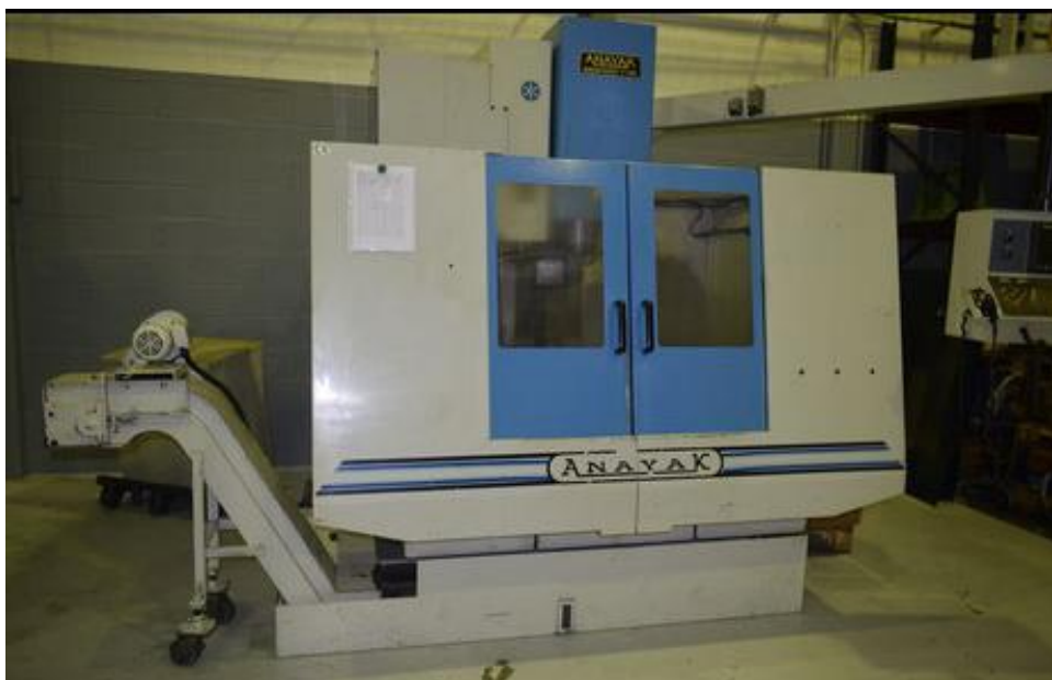
Figura 53. Fresadora vertical ANAYAK
