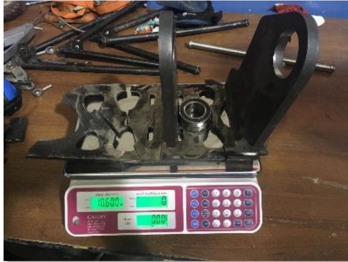
Figura 62. Pesaje de los soportes originales con rodamientos
