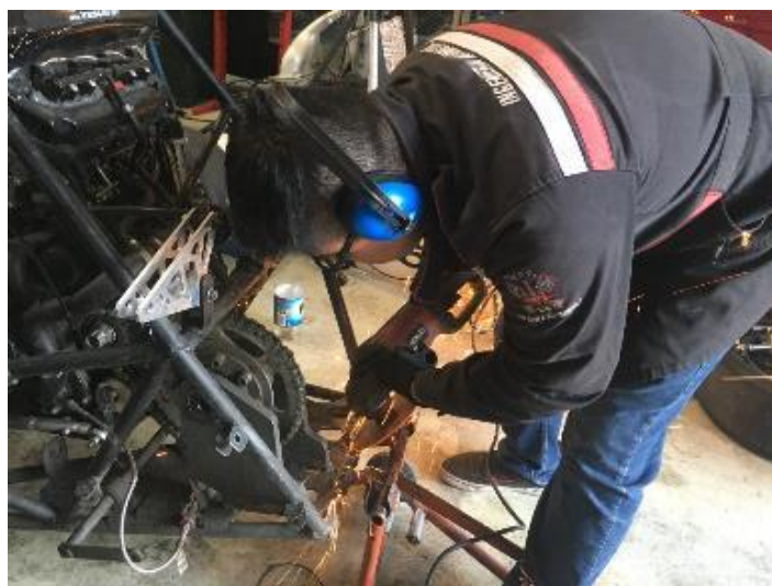
Figura 59. Proceso de corte en los cordones de soldadura
