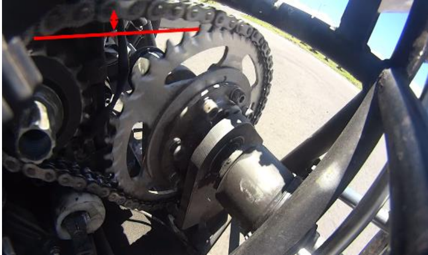
Figura 71. Funcionamiento del conjunto diferencial con soportes antiguos
