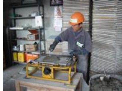
MEZCLA SE VIERTE SOBRE LA MESA VIBRADORA
