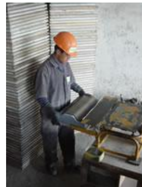
LA MEZCLA VIBRADA SE COLOCA EN EL MOLDE PLÁSTICO
