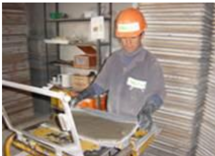
LA MEZCLA SE EXTIENDE SOBRE LA MESA VIBRADORA
