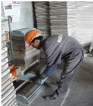
LA MEZCLA SE CURA DURANTE 24 HORAS EN EL MOLDE
