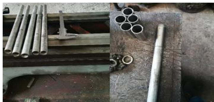
a) Tubos b) Bocines Figura 40 Tubos y bocines en acero inoxidable
