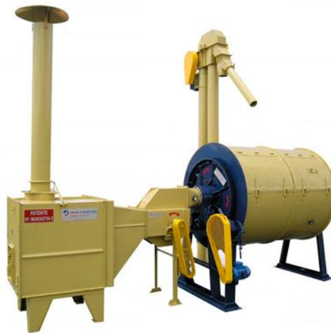
Figura 21 Secadora de cacao por combustión Fuente: Fundidora del Norte, (2014)
