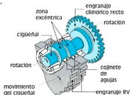
Figura 12 Componentes internos de un motorreductor
