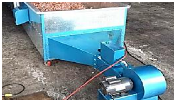
Figura 22 Secadora de cacao por GLP Fuente: WILPAC, (2016)
