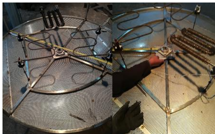
Figura 38 Chumacera en la parte inferior de la plancha perforada
