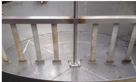
Figura 37 Chumacera parte superior de la plancha perforada
