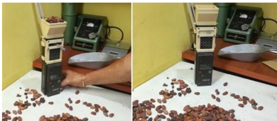
Figura 52 Medición de la humedad
