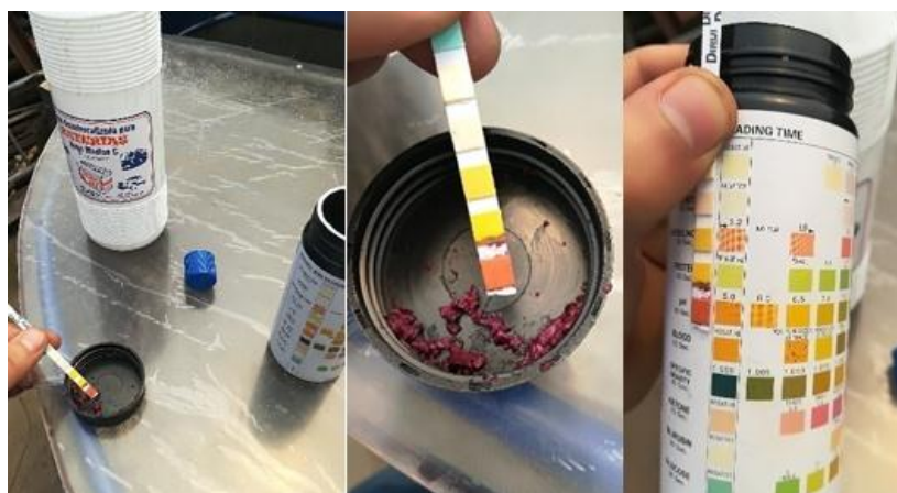
Figura 48 Medición inicial del Ph del grano de cacao
