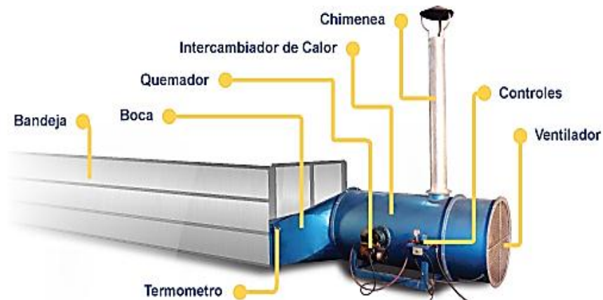
Figura 6 Secadora de cacao industrial Fuente: SIRCA, (2017)
