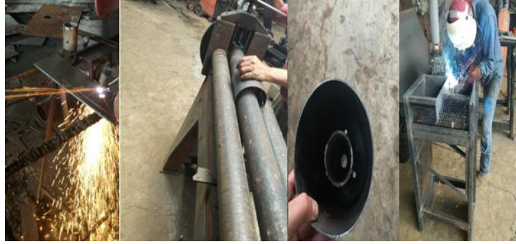
Figura 34 Construcción del quemador
