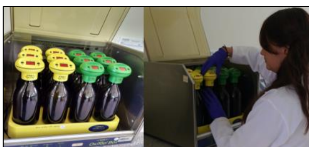
Figura 28 Determinación DBO5 en Oxitop
