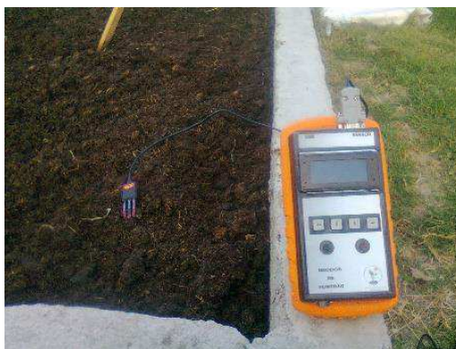
Figura 9. Sensores de humedad
