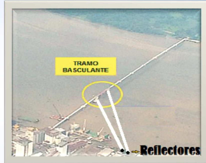
Como señalización nocturna, dos reflectores pueden iluminar los pilares en donde están posados los brazos basculares, estos iluminarían las marcas diurnas.
