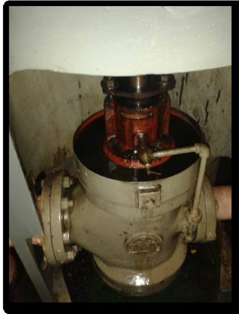
Figura 2.22 Bomba de aceite Fuente: Buque Escuela Marañón Elaborado por: DAVID ANDRÉS DELGADO NÚÑEZ
