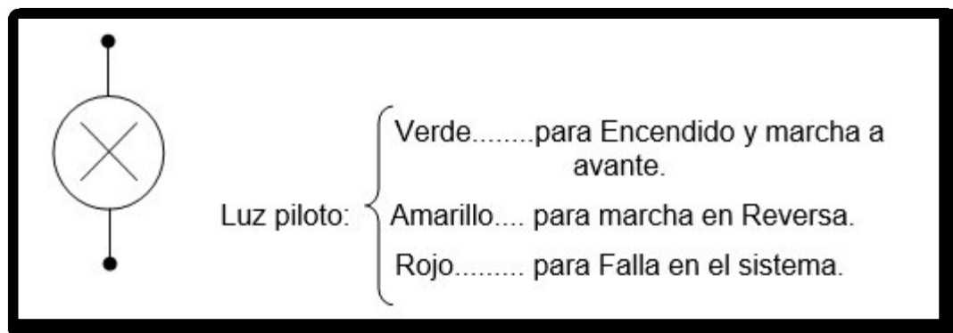
Figura 2.7 Simbología de una luz piloto Fuente: (Meza, Controles Eléctricos y Electrónicos, 2007)
