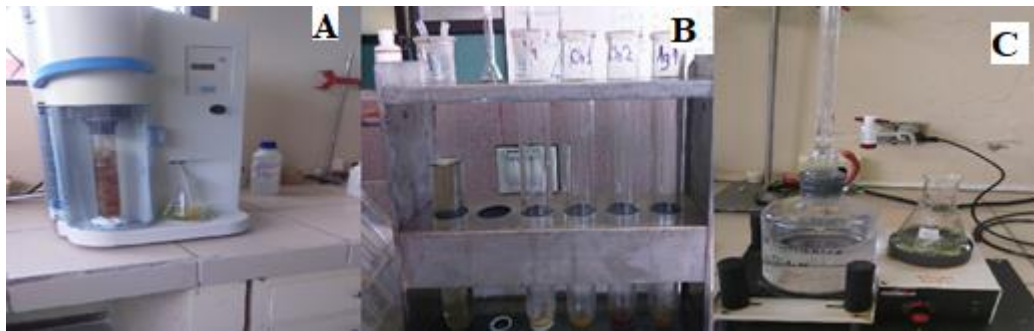
Figura 9 Determinación del porcentaje de proteína para Arthrospira platensis por el método de Kjeldahl a) Digestión; b) Destilación; c) titulación
