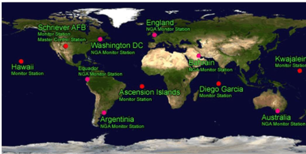
*Figura 16.* Estaciones de seguimiento y la estación principal de control.
