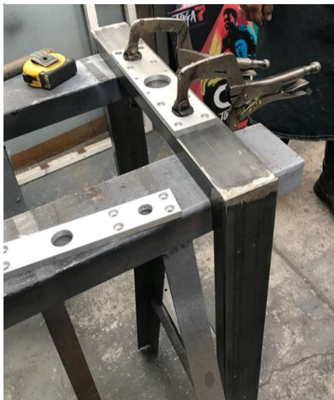
Figura 106 Perforación en el bastidor según las placas de aluminio.
