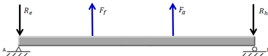
Figura 51 Esquema fuerzas plano YZ eje X
