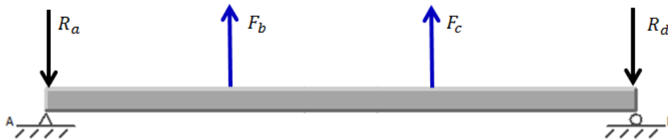
Figura 35 Esquema fuerzas plano XZ eje Z
