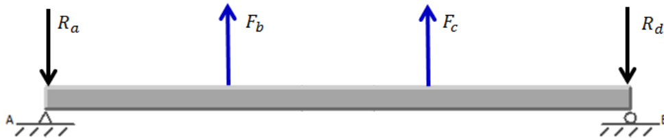
Figura 50 Esquema fuerzas plano XZ eje X
