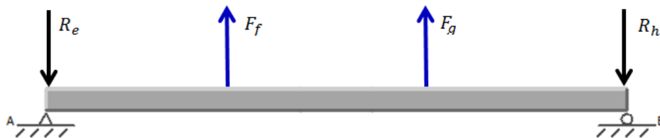
Figura 37 Esquema fuerzas plano YZ eje Z
