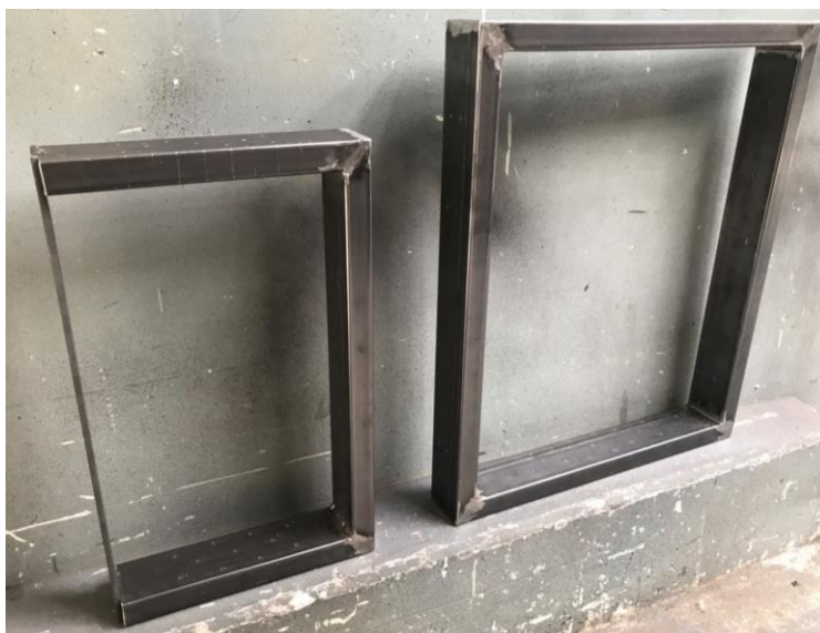
Figura 105 Bastidor equipo CNC. Tubo rectangular 60x30x1.5
