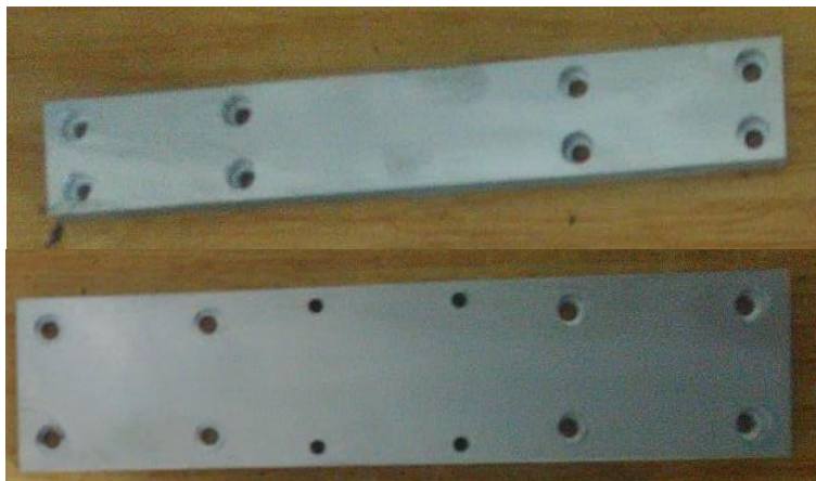
Figura 104 Placas laterales soporte eje Y Frontal: 250x38x10 Posterior: 250x60x10
