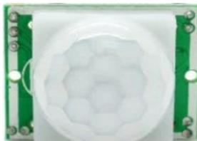
**Figura 7.** Sensor de movimiento PIR HC-SR501.
