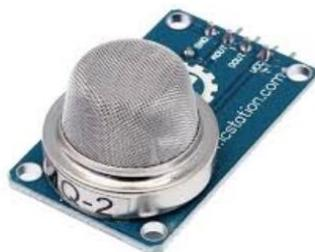
**Figura 9.** Sensor de Gases Flamables y Humo, MQ2.
