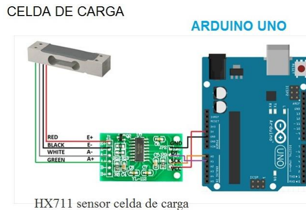
Figura 70. Conexión de celda de carga en arduino
