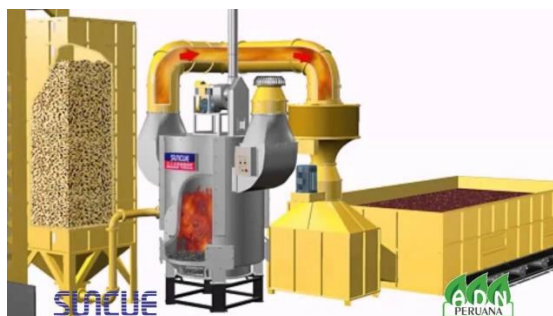
Figura 26. Secador con combustión de biomasa
