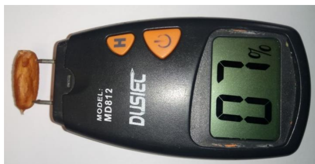
Figura 122. Medición de humedad en cacao nacional
