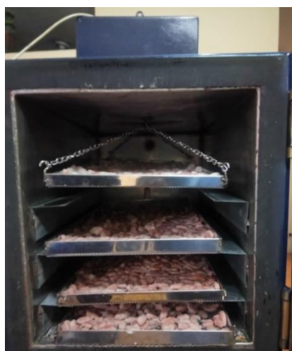
Figura 113. Producto cargado en la cámara de secado
