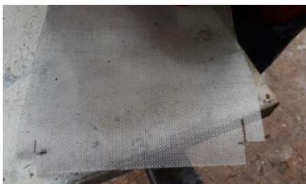
Figura 89. Corte de la malla de acero inoxidable
