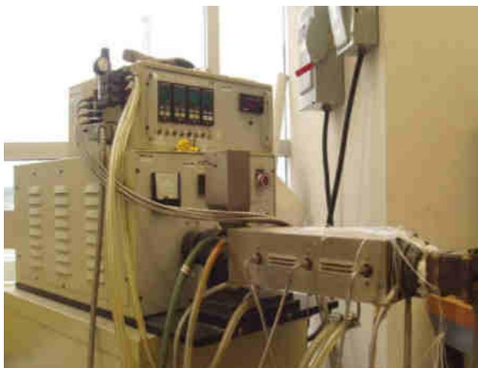
**Figura 3** Extrusor Brabender 3/4'' de tornillo simple
