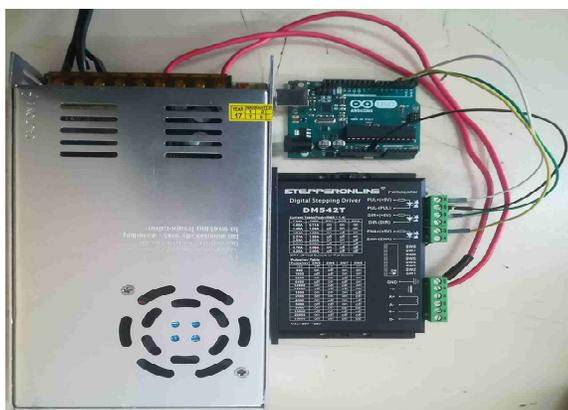
**Figura 80** Controlador, driver y fuente de alimentación.
