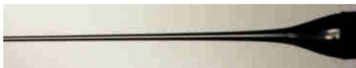
**Figura 18** Cono y jet de solución al 2% de óxido de polietileno.
