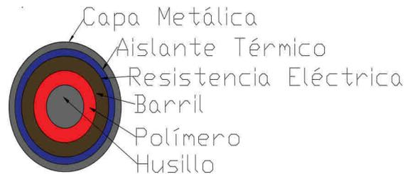
**Figura 68** Ubicación de los elementos en la extrusora
