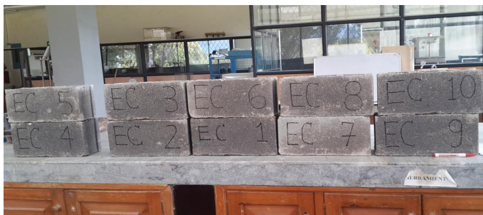
Figura 51. Bloques convencionales utilizados para el ensayo de resistencia a la compresión
