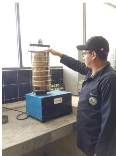
Figura 28. Separación de las partículas mediante tamizado mecánico
