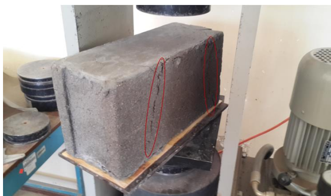
Figura 55. Fisuras en el bloque comprimido
