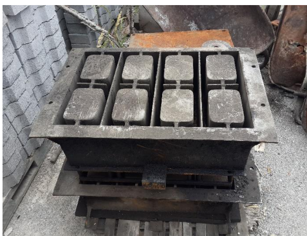
Figura 35. Molde metálico utilizado para la elaboración de los bloques
