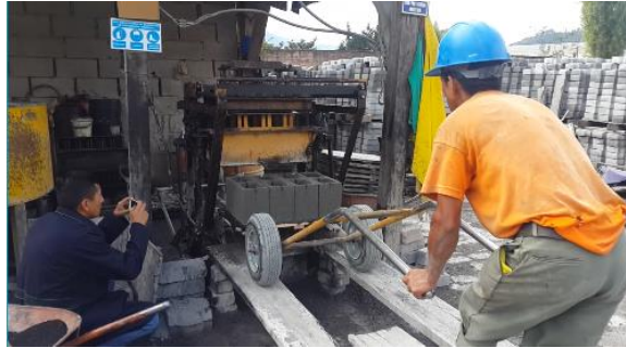
Figura 5. Retiro de los bloques con el coche transportador de bloques
