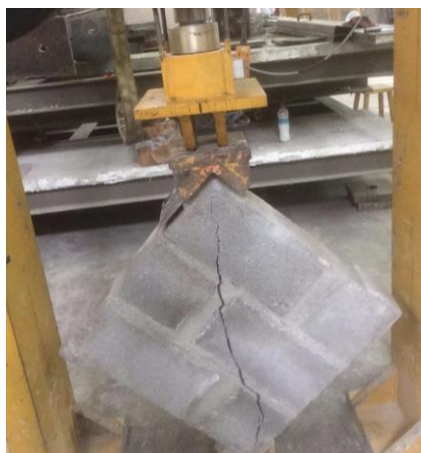
Figura 83. Fallas en el murete del ensayo de tensión diagonal
