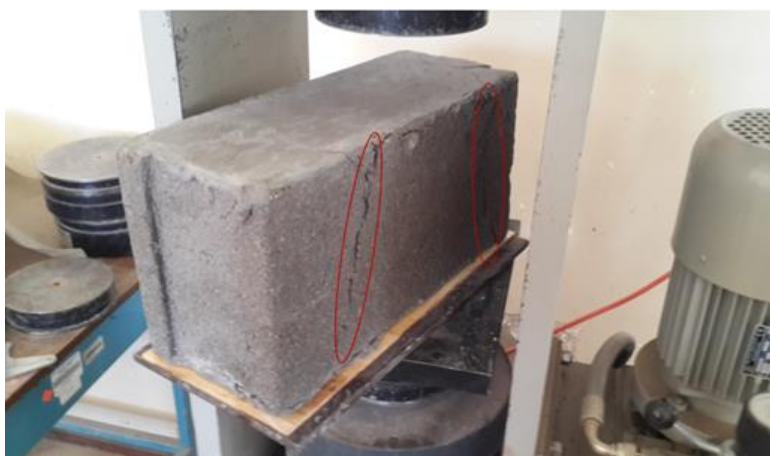
Figura 41. Fisura del bloque comprimido
