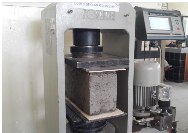
Figura 40. Colocación del bloque para el ensayo en la máquina de compresión simple
