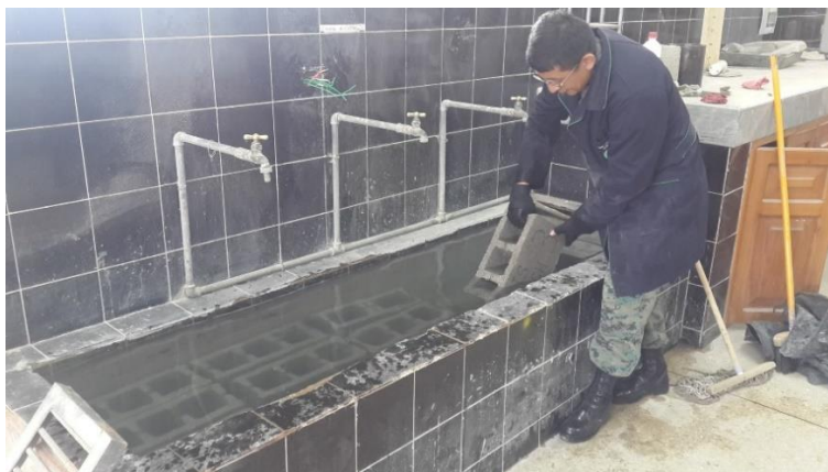
Figura 43. Saturación de los bloques en el tanque de curado
