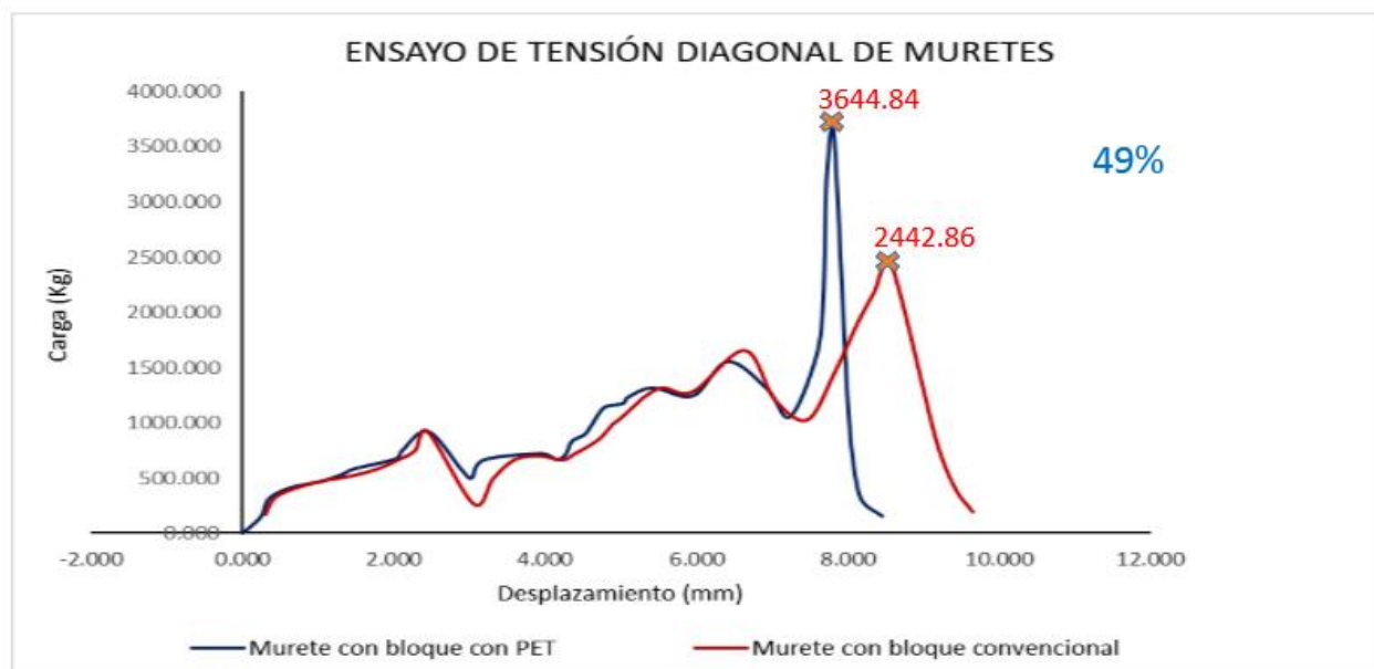
Figura 85. Ensayo a la compresión de muretes con bloques convencionales y con PET
