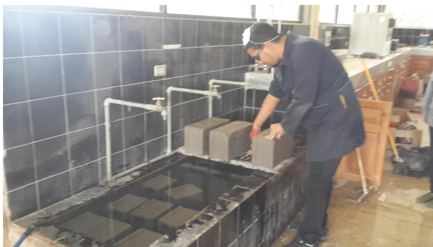
Figura 44. Retiro del agua de la superficie del bloque
