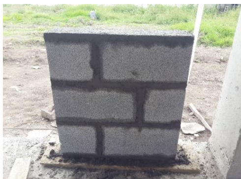
Figura 47. Murete elaborado con el 25 % de PET
