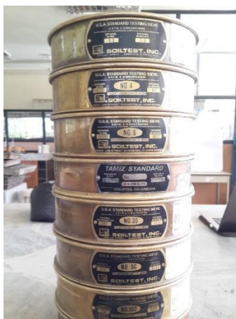
Figura 27. Tamices para realizar la granulometría de la arena-PET-fibras de caucho
