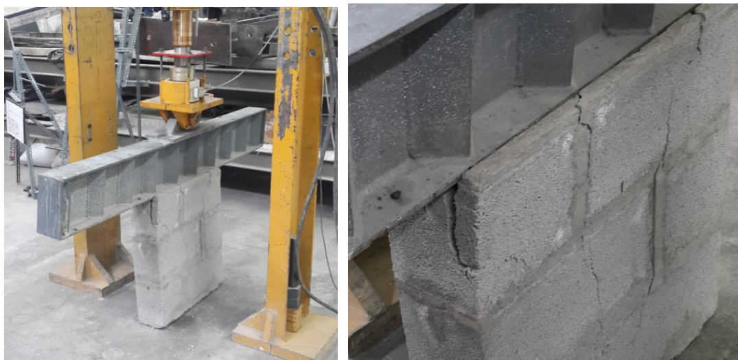
Figura 80. Fallas en el murete del ensayo de compresión
