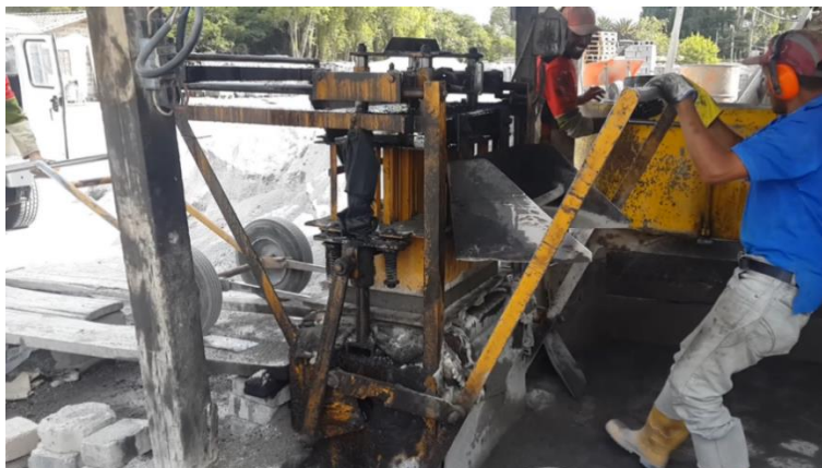
Figura 23. Levantamiento de los pisones por medio de una palanca
