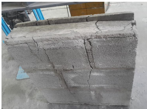
Figura 82. Fallas en el murete del ensayo de compresión
