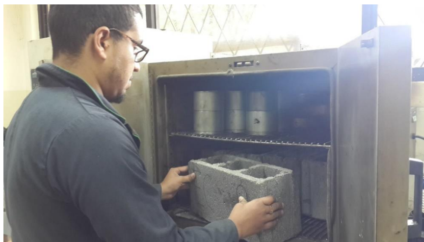
Figura 45. Secado del bloque en el horno ventilado
