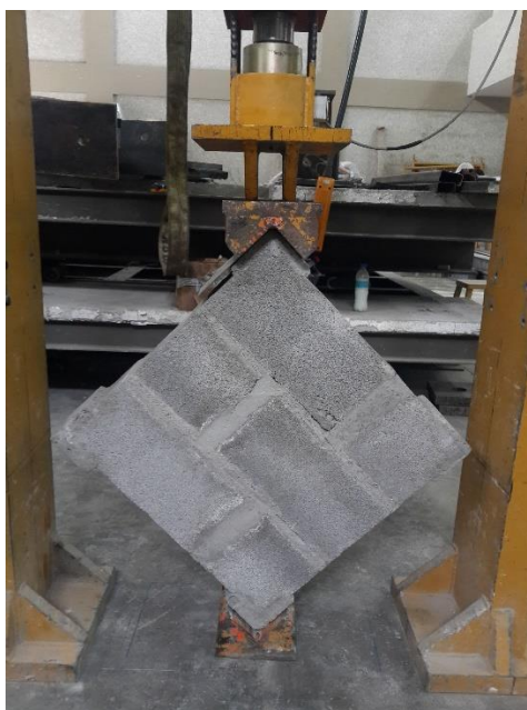
Figura 50. Ensayo de tensión diagonal
