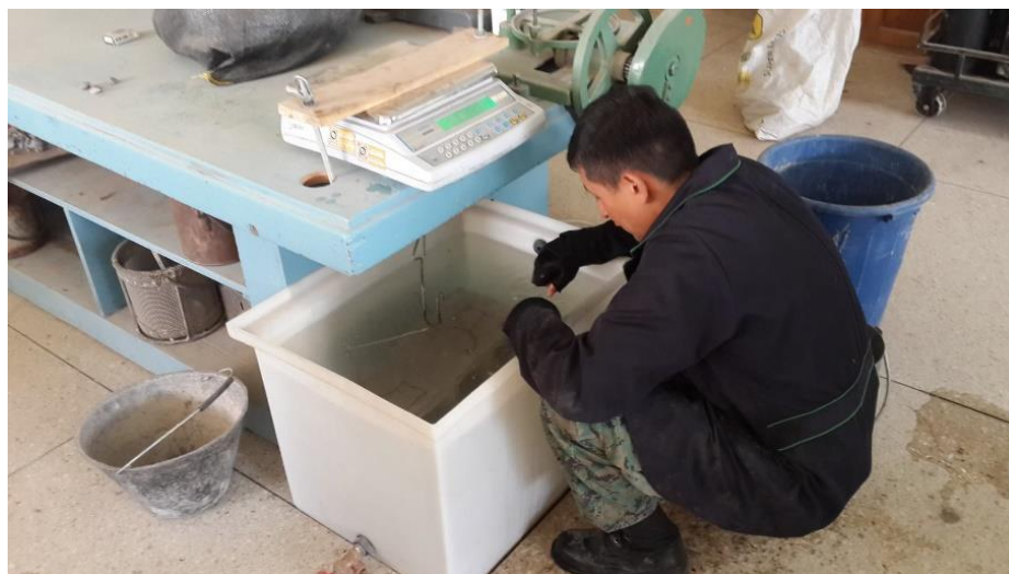
Figura 42. Peso inicial del bloque saturado
