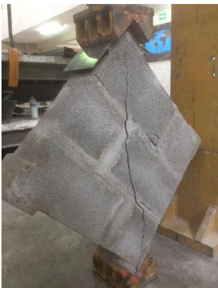
Figura 81. Fallas en el murete del ensayo de tensión diagonal
