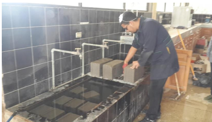
Figura 39. Colocación de los bloques en el tanque de curado
