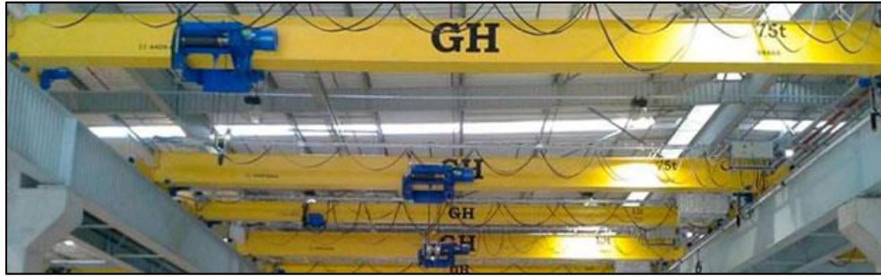
Figura 3. Grúa puente monorraíl Fuente: (GH CRANES & COMPONENTS, 2018)
