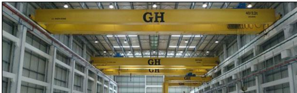
Figura 4. Grúa puente birraíl Fuente: (GH CRANES & COMPONENTS, 2018)
