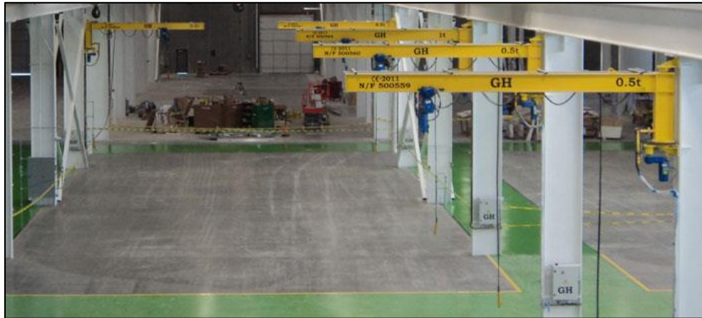
Figura 7. Grúa pluma mural Fuente: (GH CRANES & COMPONENTS, 2018)
