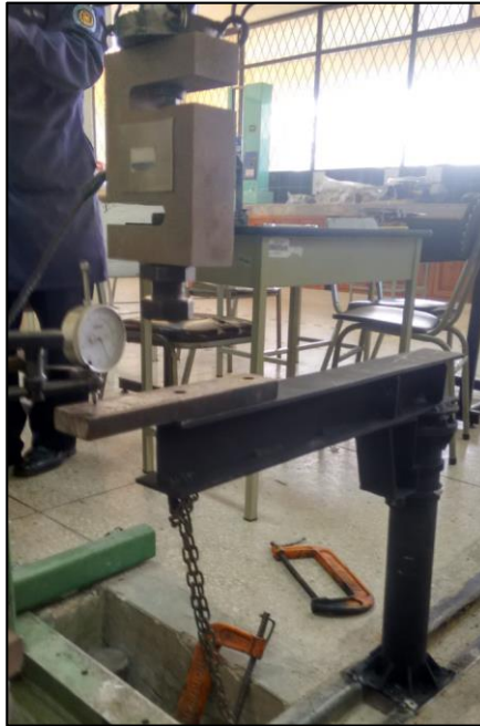
Figura 43. Ensayo de deflexión en el modelo a escala
