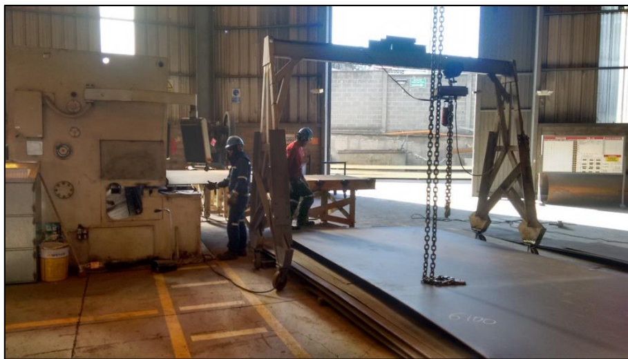
Figura 2. Corte de planchas en la cizalla hidráulica CNC
