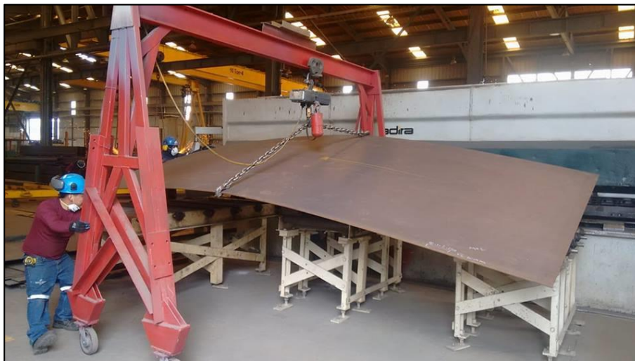
Figura 1. Posicionamiento de planchas en la cizalla hidráulica CNC.
