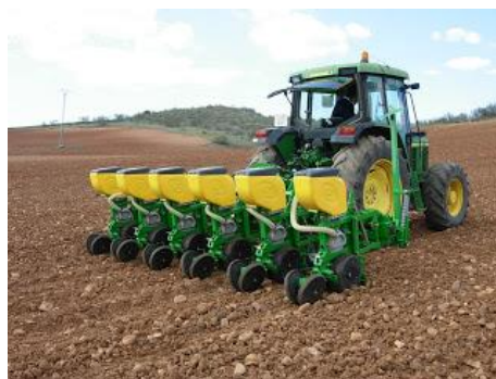
Figura 19. Sembradora volumétrica mecánica acarreada por un tractor.
