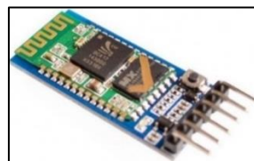
Figura 69. Módulo de comunicación Bluetooth. Fuente: (LionChip Electrónica, 2016)
