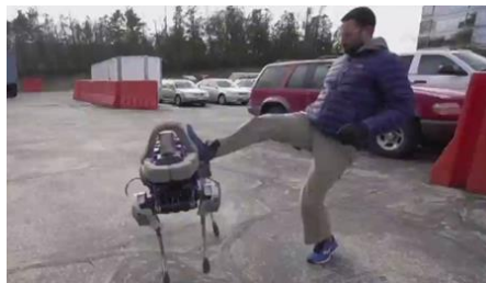
Figura 4. Prueba de estabilidad de un robot zoomórfico. Fuente: (Parke, 2015)
