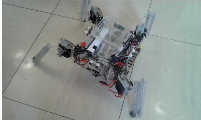
Figura 85. Caída provocada por inestabilidad.
