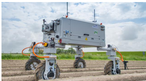
Figura 9 . Robot zoomórfico con ruedas y articulaciones capacitado para distinguir malas hiervas. Fuente: (Moya, 2015)
