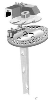
Figura 24. Dosificador de placa horizontal. Fuente: (Sembradoras, p. 18)
