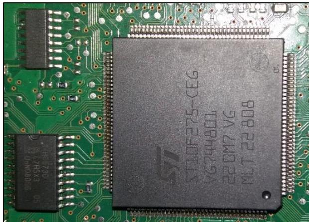
**Figura 6.** Microprocesador ECU KEFICO M7.9.8
