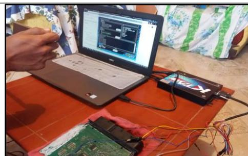
Figura 47. K-TAG conectado a la centralita
