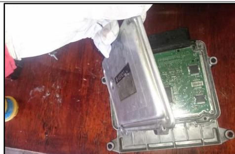
**Figura 35.** Carcasa de la ECU descubierta.
