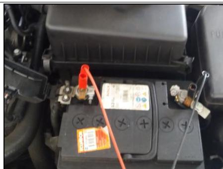
**Figura 113.** Conexión cables del medidor de rpm
