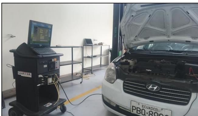
**Figura 144.** Prueba de emisiones de gases de escape
