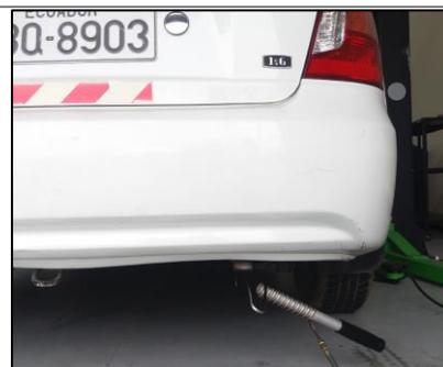
**Figura 116.** Sonda en el tubo de evacuación de gases
