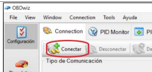
**Figura 102.** Conexión OBDwiz-ECU
