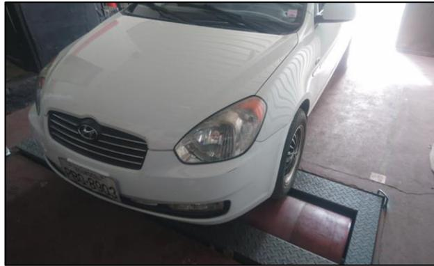
**Figura 122.** Colocación del vehículo en el dinamómetro
