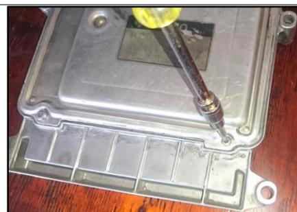
**Figura 34.** Desmontaje de la tapa
