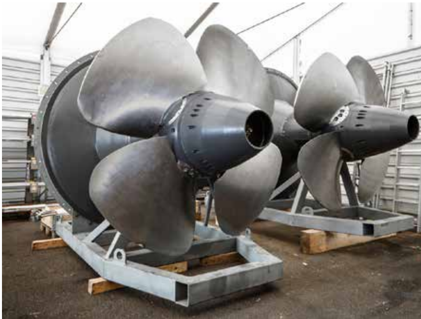
Figura 6.16 Turbinas Kaplan antes del montaje. Fuente: GLOBAL Hydro (2017)
