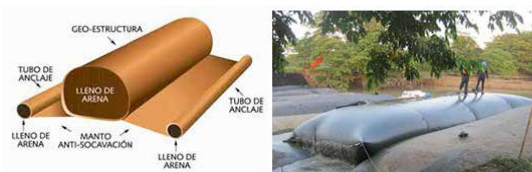
Figura 1.6 Geo-estructuras. Fuente: PIVALTEC (2017)
