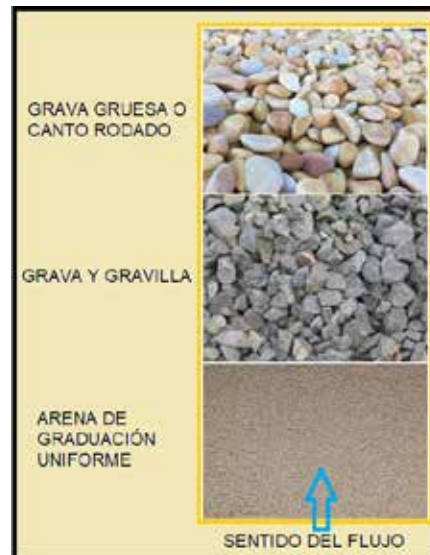
Figura 4.38 Capas de un filtro invertido
