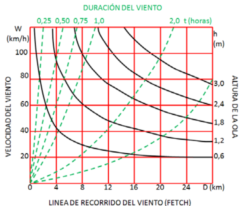
Figura 5.24 Abaco para determinar la altura de la ola según el USACE
