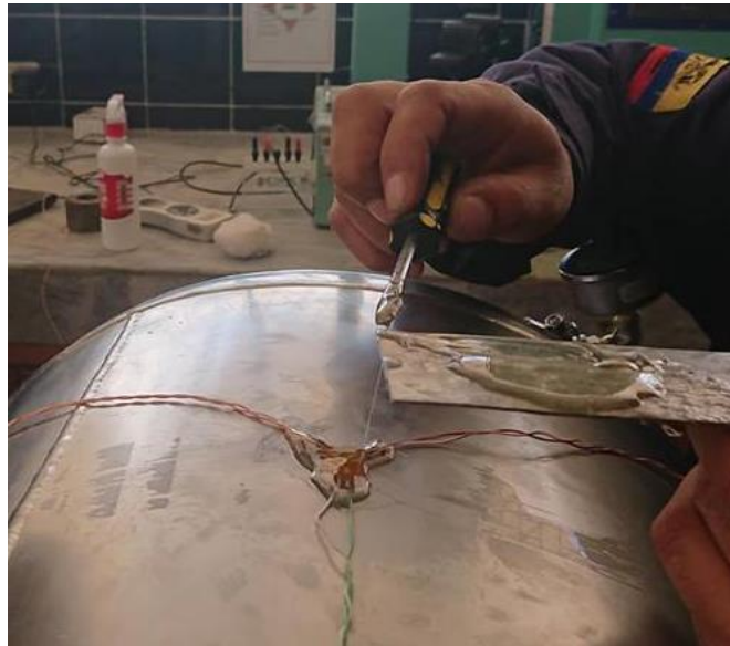
Figura 42. Recubrimiento de los medidores de deformación con resina epóxica
