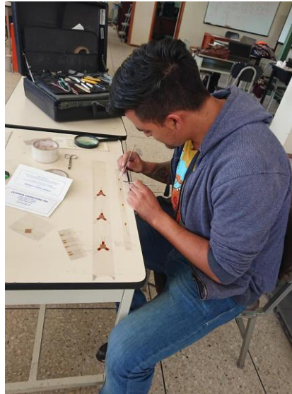
Figura 40. Colocación de galgas y rosetas sobre cinta adhesiva
