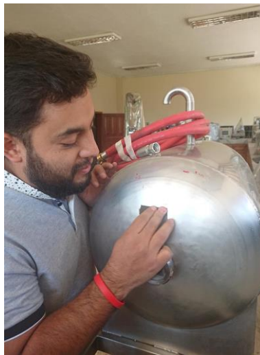
Figura 39. Limpieza de superficies para instalación de medidores de deformación
