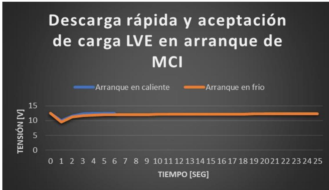
El tiempo que se demora en recuperar su tensión nominal la batería HV a temperatura ambiente es un 60% más lenta que, a temperatura óptima de funcionamiento del MCI
