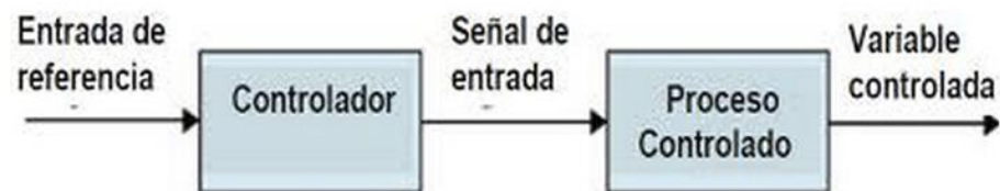
Figura 7 Sistema de control abierto
