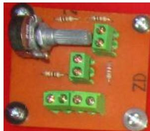
**Figura 48.** PCB del circuito FSR soldado
