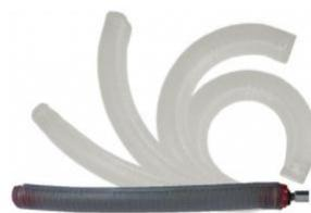
**Figura 19.** Actuador reforzados con fibra
