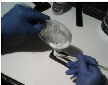
**Figura 55.** Relleno de mezcla en molde abierto
