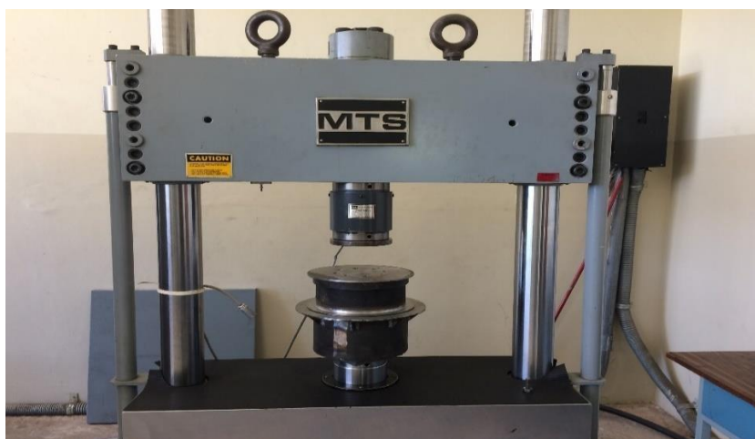
Figura 25 Máquina de ensayos MTS, junto a soportes estructurales y probeta de ensayo.
