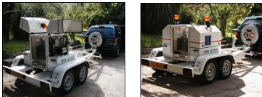
Figuras 3.14: Deflectómetro de impacto FWD. (Inextec, 2007)
