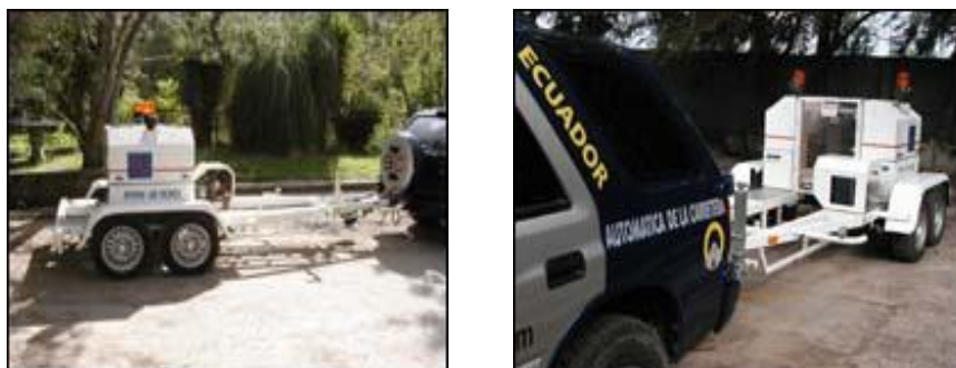
Figuras 3.13: Deflectómetro de impacto FWD. (Inextec, 2007)
