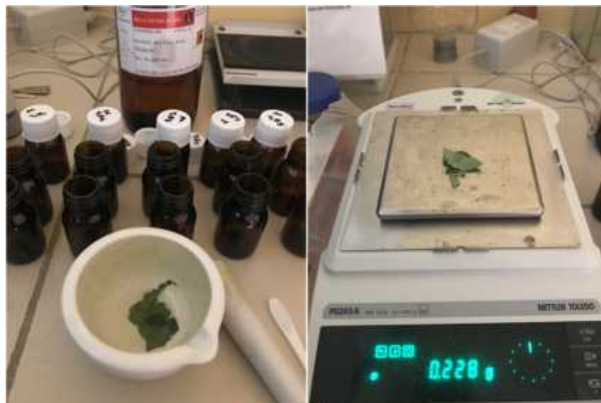
Figura 3 Preparación de la muestra, para extracción de Clorofila con los diferentes Extractantes
