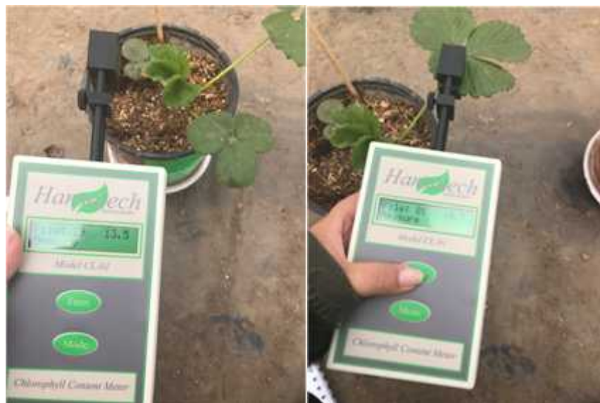
Figura 2 Medición de la Clorofila en campo con el Medidor
