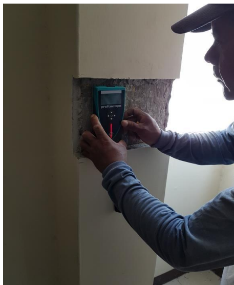
Figura 19. Escaneo de columna con equipo Profoscope
