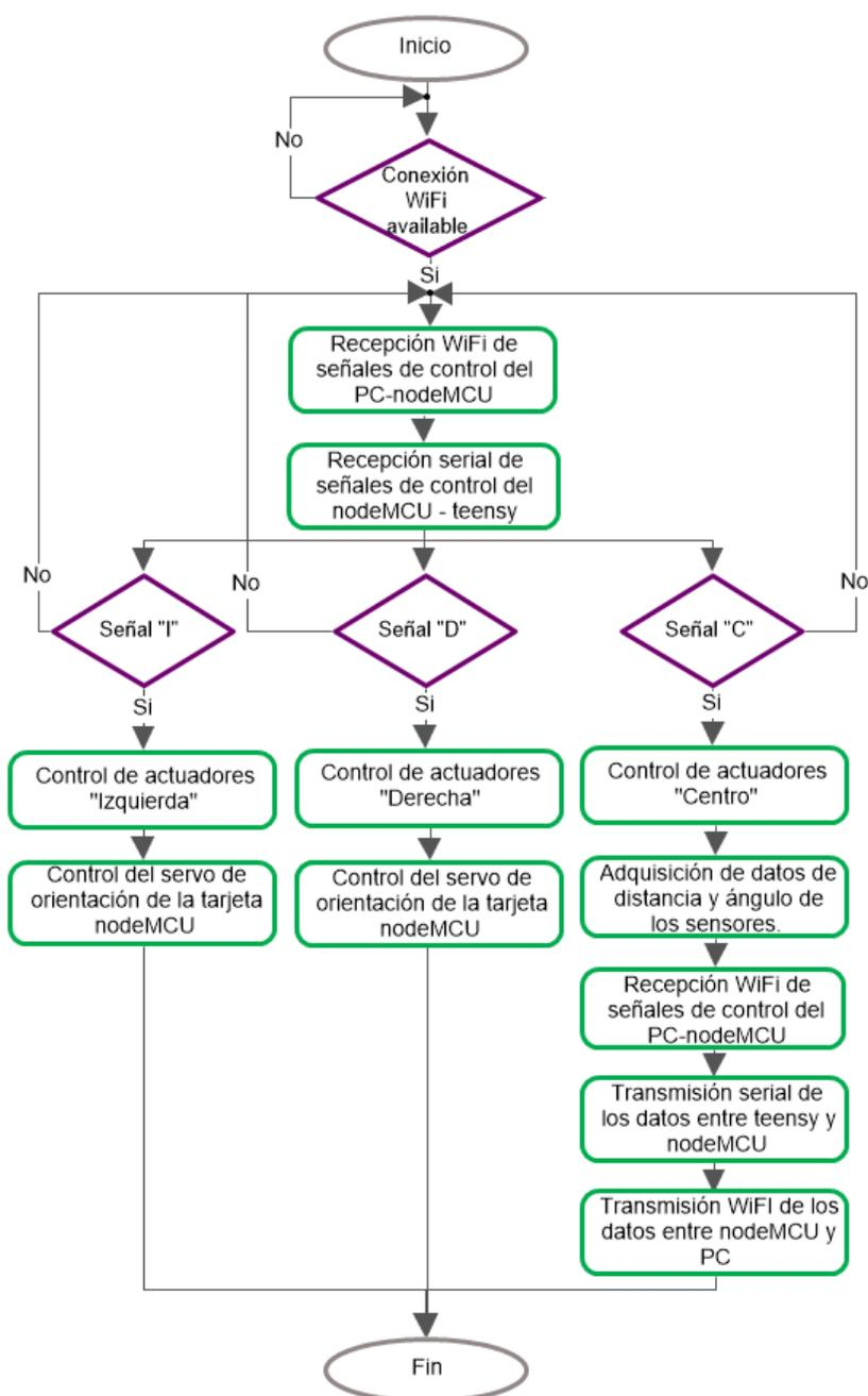
**Figura 51.** Diagrama de flujo del proceso de envío de señales al robot desde la PC.
