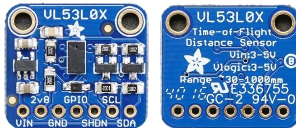
**Figura 33.** Sensor láser VL53LOX.
