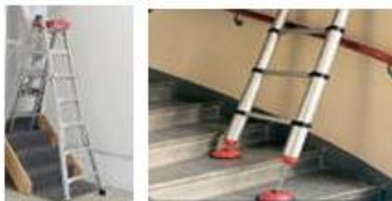
Figura 43. Colocación en peldaños
