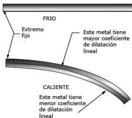
Figura. II.24. Conjunto de dos barras metálicas con coeficientes de dilatación diferentes
