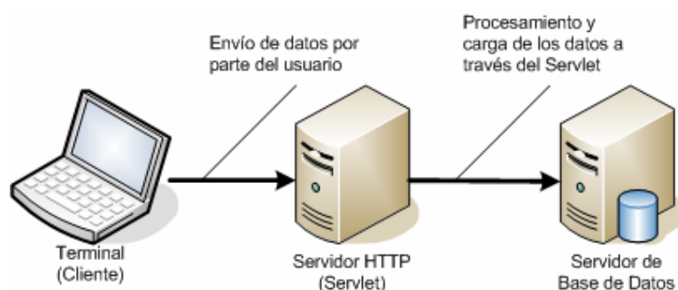
Figura. 3.1. Diagrama esquemático sobre el manejo de conexiones HTTP a través de los Servlets
