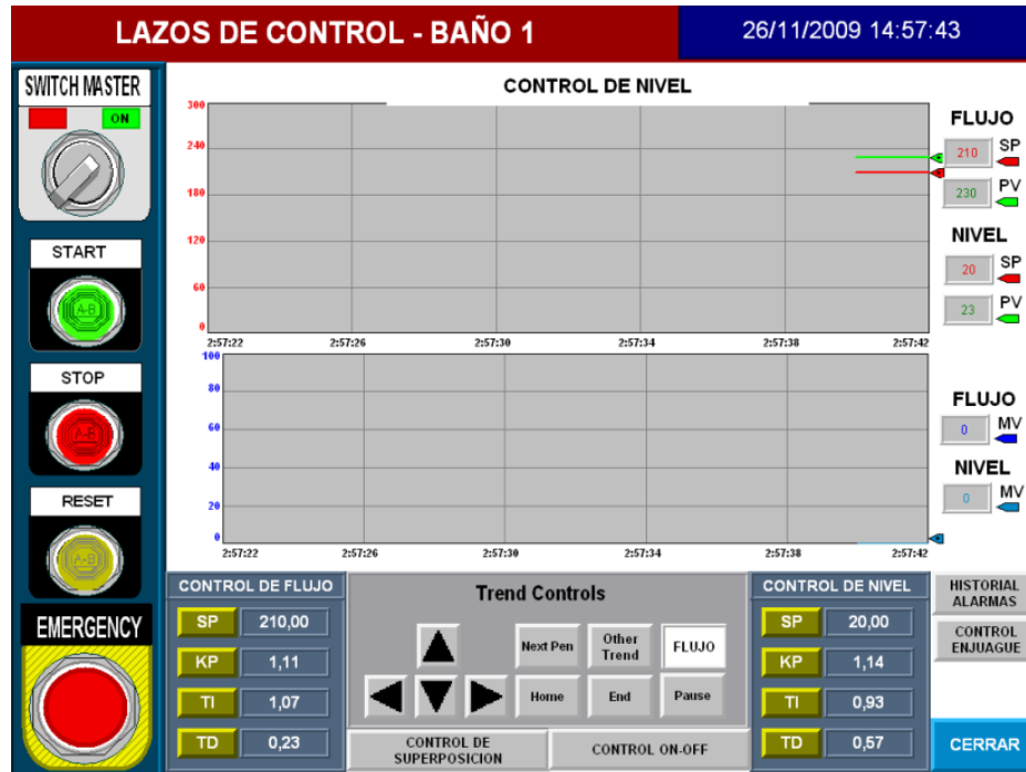
Figura. 4.53 Pantalla de Lazos de Control (Variable Flujo y Nivel) – Baño 1
