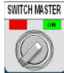
Figura. 4.41 Selector Switch Master Modo automático
