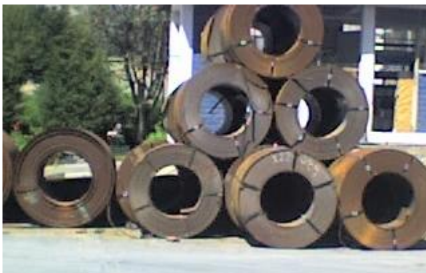
Fotografía 3.8 Almacenamiento de bobinas a la intemperie
