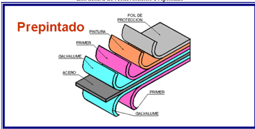
Grafico 3.4 Estructura de recubrimiento Prepintado
