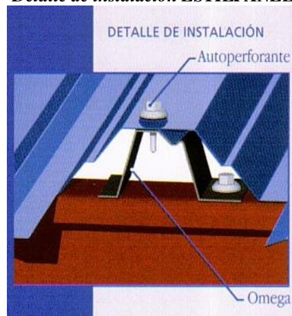
Grafico 3.2 Detalle de instalación ESTILPANEL
