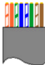
Figura. 2.2 Norma EIA/TIA 568B
