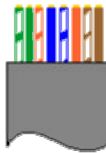
Figura. 2.1. Norma EIA/TIA 568A
