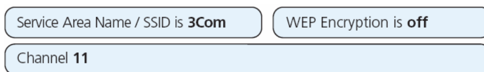
Figura. 3.1. Parámetros originales de un AP 3com 3RWF454G72
