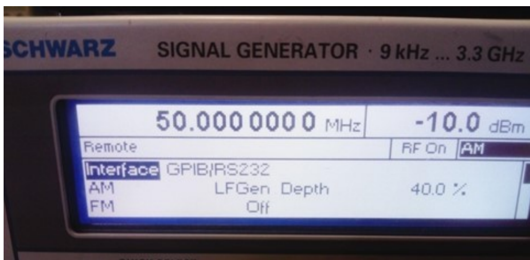
Figura 39 Generador activado la modulación AM mediante comunicación serial.
