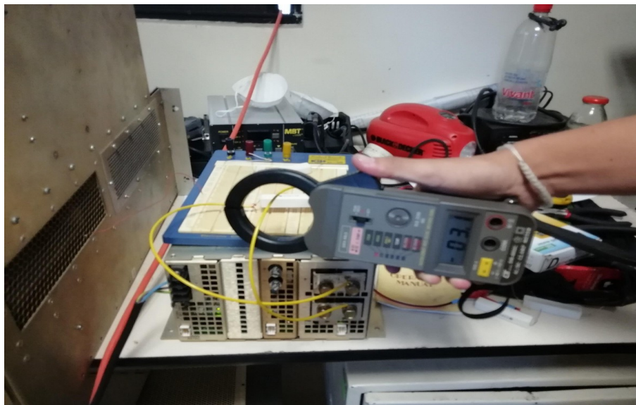
Figura 15 Prueba del funcionamiento de la fuente de 36 voltios con una carga de 10
