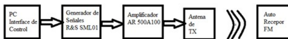
Figura 51 Escenario Jamming a receptor de prueba a 2m de altura.
