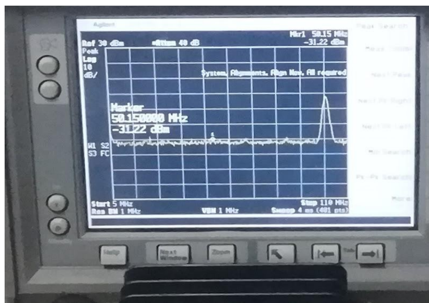
Figura 20 Analizador Espectros a la salida del driver, con un atenuador de 40 dB.
