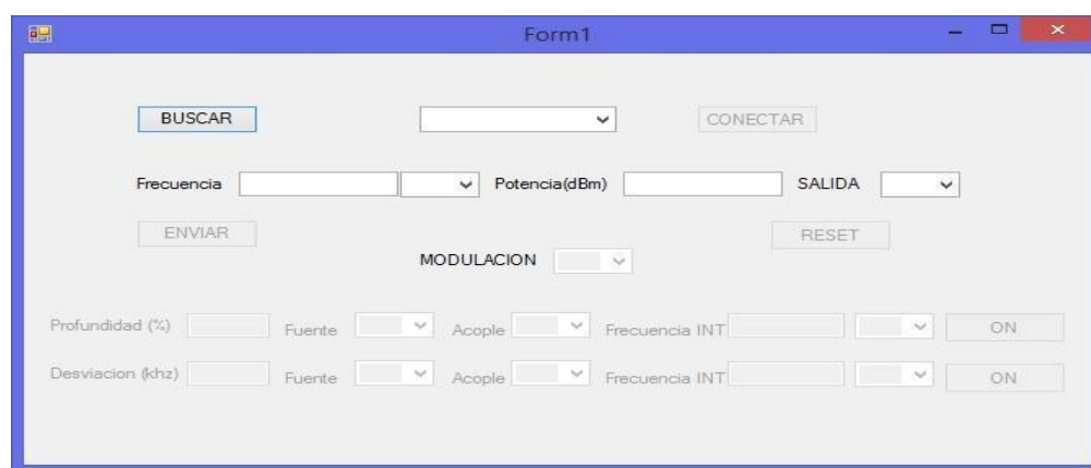
Figura 43 Interfaz de usuario desarrollada para controlar el generador SML01.
