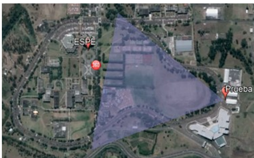
Figura 56 Cobertura del campus prueba a 5,5m de altura, banda de 10 – 1000MHz.
