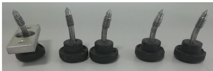
Figura 45 Tornillos de fijación de los dipolos de la antena de HF.
