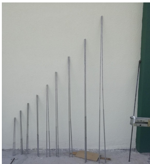
Figura 44 Dipolos de la antena de VHF.
