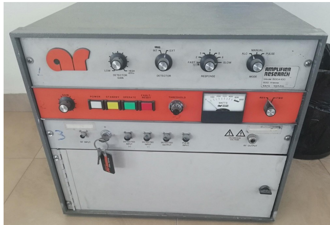
Figura 5 Amplificador de potencia de 500 watts para la banda de 10 kHz a 100 MHz marca Amplifier Research .
