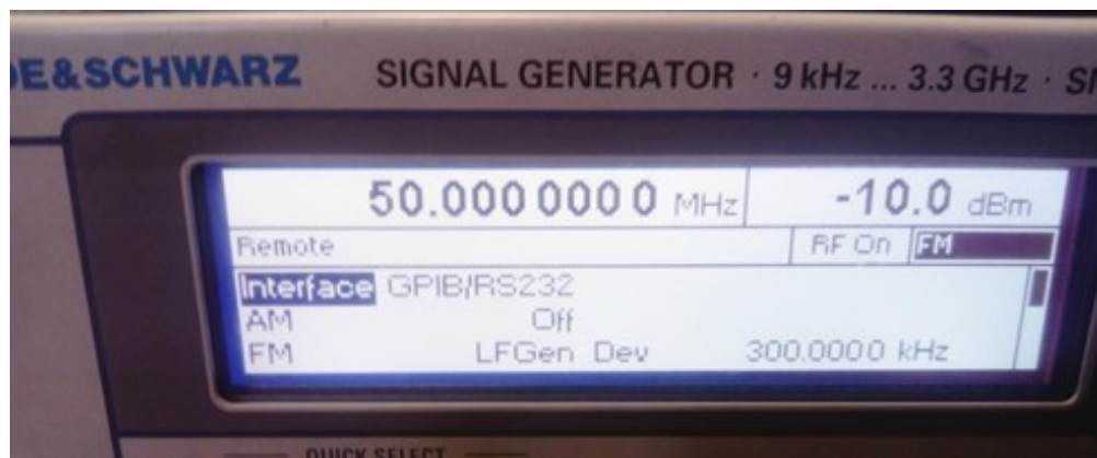
Figura 38 Generador activado la modulación FM mediante comunicación serial.
