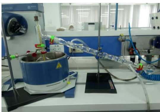
Figura 20. Equipo de destilación simple
