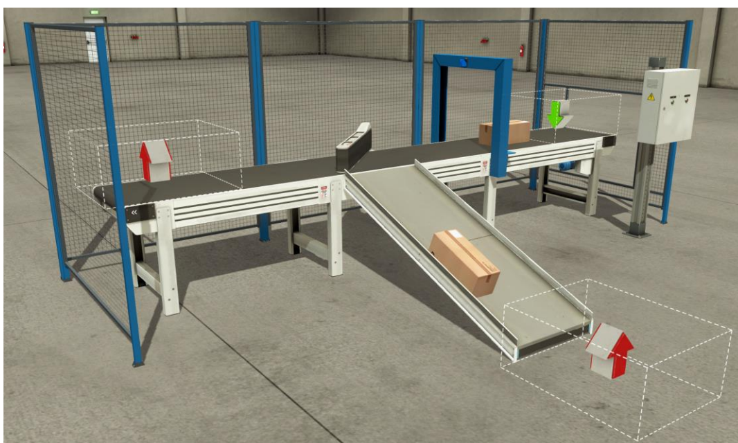
Figura 31. Estación de trabajo 3: Selector de Paquetes con Brazo Giratorio
