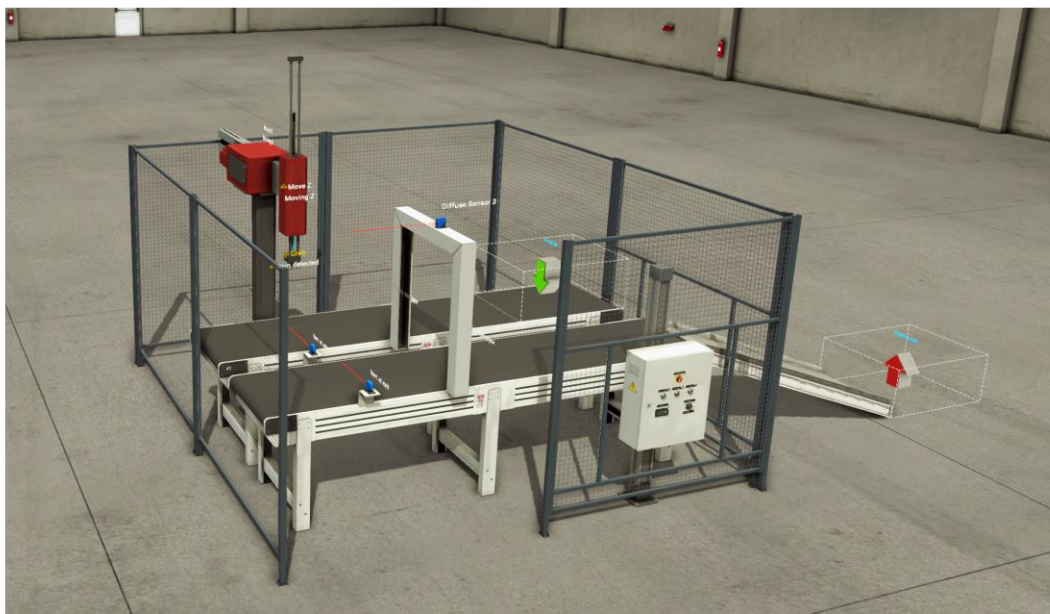
Figura 30. Estación de Trabajo 2: Pick & Place
