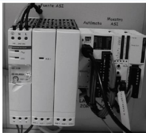
Figura 7. Fuente de alimentación AS-I (Schneider Electric). Fuente: (Penin, 2007)
