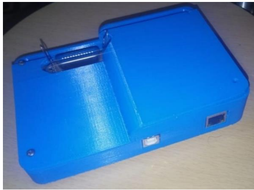
Figura 34. Carcasa fabricada en impresión 3D del módulo de E/S
