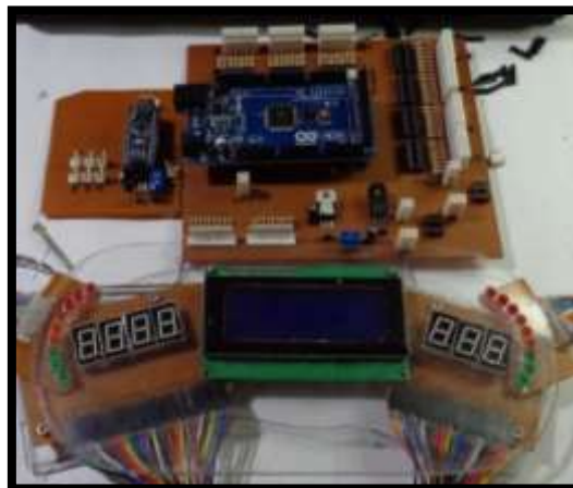
Figura 66. Placa principal y módulo de visualización para el monitoreo del prototipo de vehículo eléctrico.
