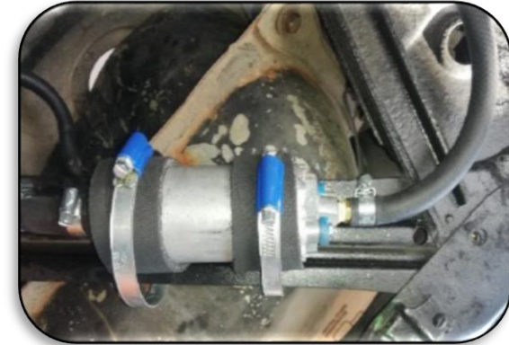
Bomba de combustible
