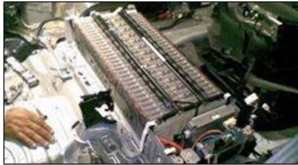
Figura 4. Batería Toyota Prius 2010. Fuente: (Gómez F, 2014)
