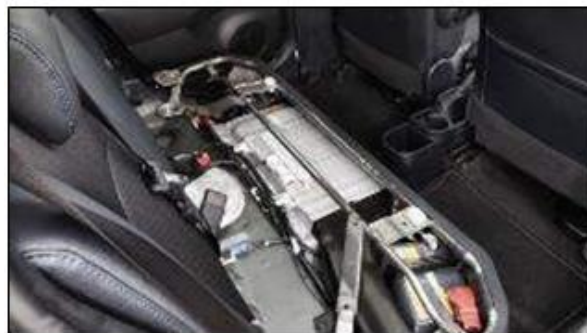
Figura 5. Batería Toyota Prius C. Fuente: (Gómez F, 2014)
