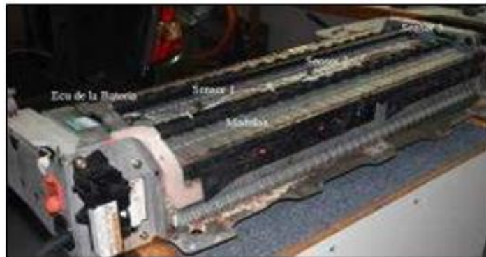
Figura 2. Batería HV del Prius 2001-2004 segunda generación.
