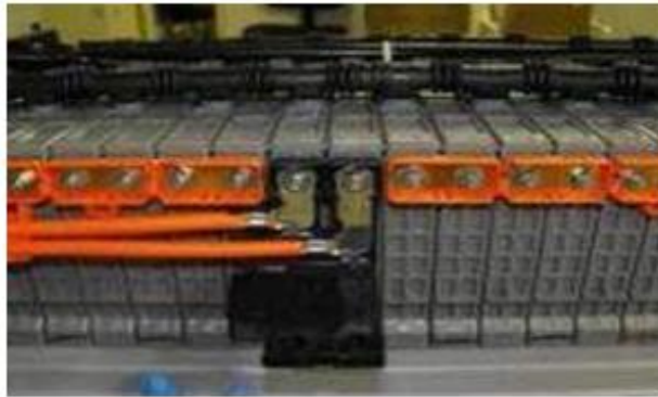
Figura 3. Batería HV del Toyota Prius 2004-2009 tercera generación. Fuente: (Gómez F, 2014)
