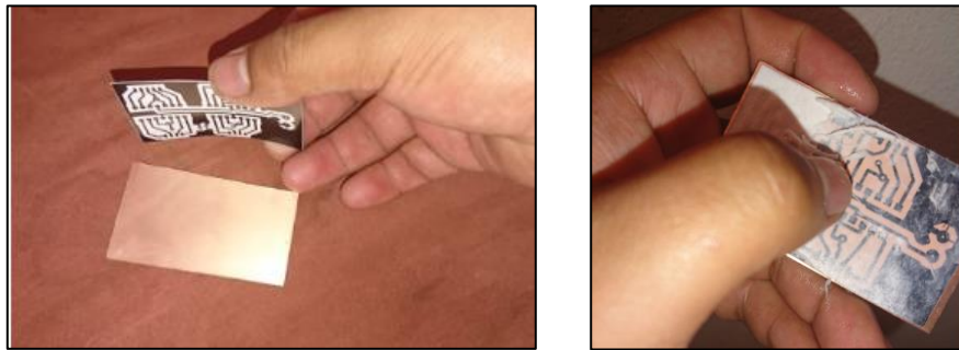
Figura 25. Proceso de elaboración de circuito impreso (Planchado)
