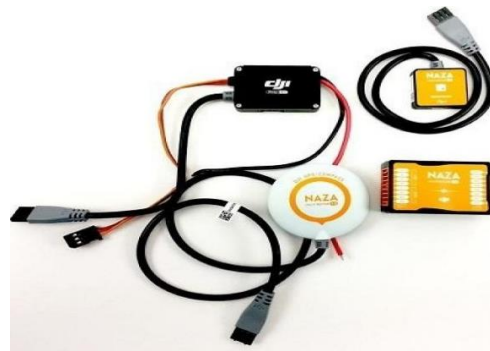
Figura 13. Tarjeta controladora NAZA- M V2 (DJI, 2018)
