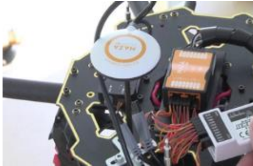
Figura 30. Posicionamiento del GPS y Controlador NAZA
