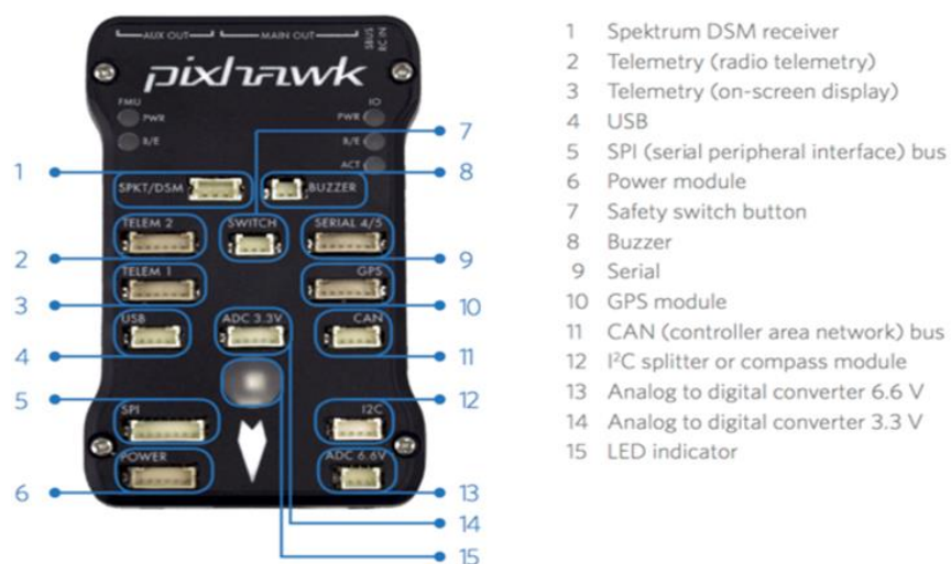
Figura 12. Tarjeta Controladora Pixhawk
