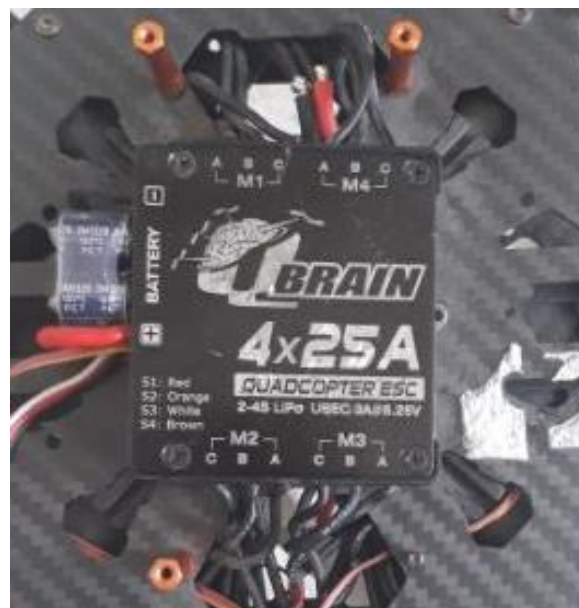
Figura 3. Módulo de driver T BRAIN 4 X25A
