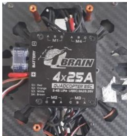
Figura 15. Módulo de ESC T Brain4x25A
